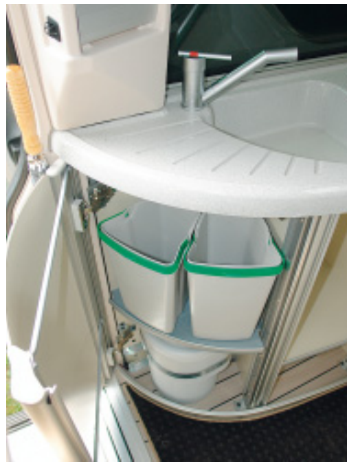
Pause für die Blechschere: Westfalia nutzt nur vorhandene Karosserieausschnitte. Hier für Strom und Wasser.
