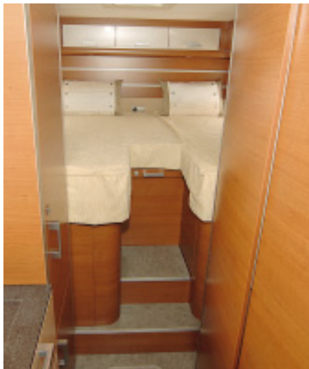
Der Aufstieg ins Heckbett führt über zwei stabile Stufen, wobei die obere sogar als Stauraum nutzbar ist. Wer will, kann eine große Liegefläche schaffen.
