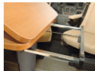
Beim Aufklappen des Tisches fährt der stützende Rahmen ganz von allein aus. Clever gemacht.
