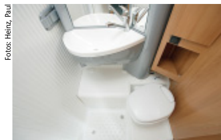
Wer duschen möchte, kann die Wand mit dem Waschbecken wegklappen.
