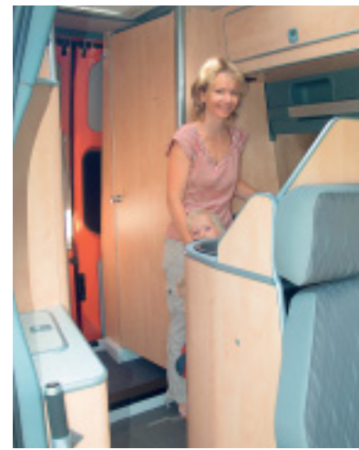
Trickreich: Die Badtür öffnet mehr als 180 Grad und arretiert in zwei Schließblechen. So lässt sich die Nasszelle samt Dusche vergrößern und gut erreichen.
