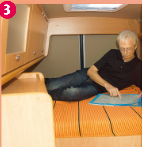
3 Quer gelegt: Das 144 mal 194 Zentimeter große Heckbett bedingt zwei relativ unauffällige Wangen an der Karosserie des Florida. Vor dem Bett entsteht durch den halb hohen, leicht schräg gestellten Kleiderschrank ein Engpass.
