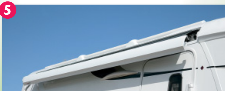
In den eleganten Dachprofilen verschwindet sogar eine ganze Markise. Die Wände selbst sind aus Alu-Sandwich mit Styroporisolierung.
