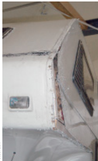
Wenn das Kantprofil entfernt ist, sieht man den Schaden. Hier müsste eigentlich die Seite ersetzt werden.
