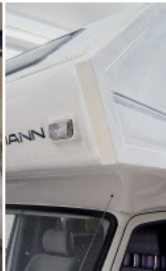
Mit einem neuen Eckprofil und der überlackierten Polyurea-Beschichtung sieht alles aus wie neu und ist dicht.
