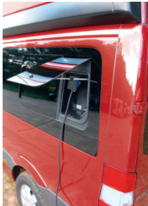
Pause für die Blechschere: Westfalia nutzt nur vorhandene Karosserieausschnitte. Hier für Strom und Wasser.
