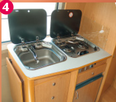
Kompakt: Der Küchenblock enthält Spüle und Zweiflammherd sowie ein hochklappbares Arbeitsfeld.
