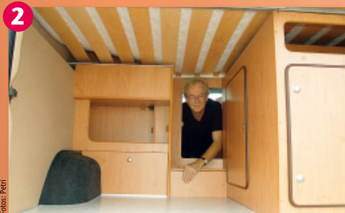
2 Von innen erreichbar: Außer Stauraum birgt die Heckgarage den Kasten für zwei große Gasflaschen sowie Serviceklappen für Heizung und Gelbatterie.
