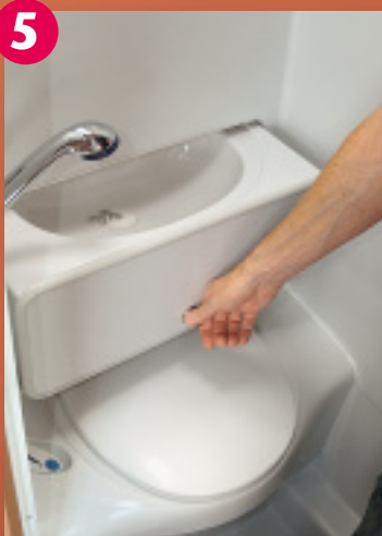
Feine Idee: Das Waschbecken verschwindet über der Kassetten-Toilette in einer Schublade, verriegelt mit einem Push-Lock-Schloss. So gewinnt das Bad an Platz, und es bleibt sogar Raum zum Duschen.
