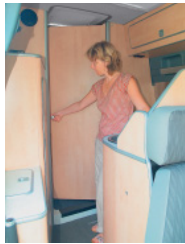
Trickreich: Die Badtür öffnet mehr als 180 Grad und arretiert in zwei Schließblechen. So lässt sich die Nasszelle samt Dusche vergrößern und gut erreichen.
