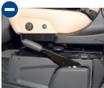
Um die Sitze drehen zu können, muss die Handbremse gelöst werden.
