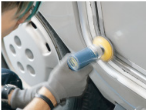
Die korrodierten Alu-Profile um Tür und Stauklappen werden im Fachbetrieb ebenfalls zunächst mit Polierwerkzeug bearbeitet. Später erfolgt zusätzlich eine pflegende Chrom- und Metallpolitur.
