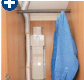
Zentralheizung und Riffelschlauch als Bügelbremse.
