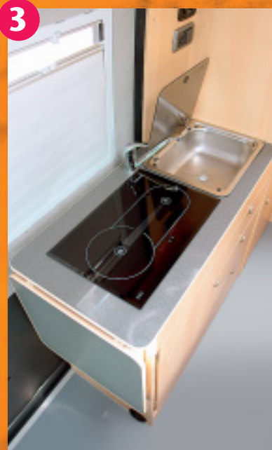
Gastfrei: Der Ceran-Kocher von Webasto läuft mit Dieselkraftstoff.
