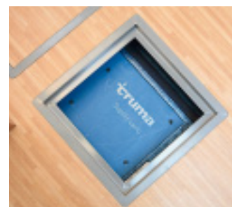
Prima Klima: Warmwasserheizung mit Cockpit-Kreislauf und Unterflur-Klimanlage für den Wohnraum.
