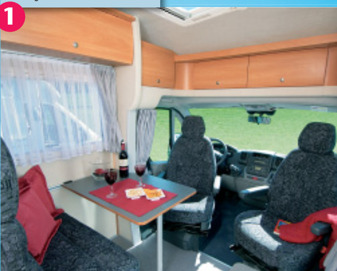
1 Wo sonst über dem Fahrerhaus nur eine Ablagefläche ist, verbaut Tikro beim Halbintegrierten Oberschränke – der Unterschied zum Teilintegrierten.
