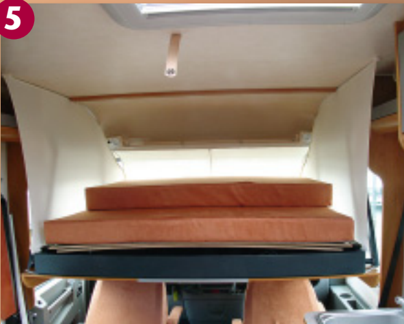
Der City-Van adaptiert das bewährte Hubbett der Konzernschwester Frankia. Mit 140 cm ist es allerdings nicht allzu breit geraten.
