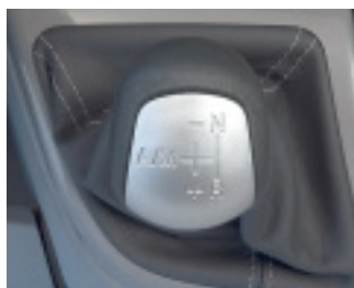
A und M stehen für Automatik- und Manuell-Modus. In M fährt der Ducato auf Wunsch im zweiten Gang an.
