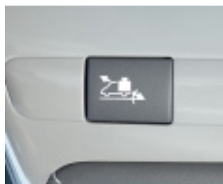
Für Berg- oder schnelle Autobahnfahrten lässt sich das Getriebe auf spätere Schaltpunkte eichen.
