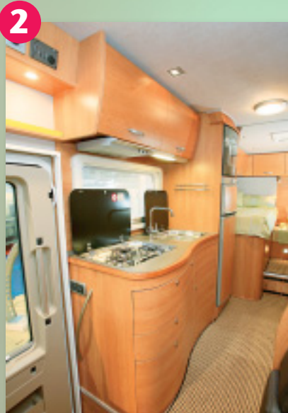
Links: Unter den Wasserhahn in der Küchenzeile passen selbst größere Kochtöpfe. Oben: Der Kühlschrank fasst 175 Liter. Als Option baut Eura einen Backofen mit Grill ein.
