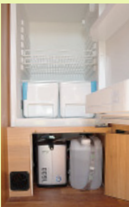
Die Brennstoffzelle speist auch den Kompressorkühlschrank.
