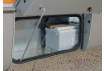
Die Elektrozentrale des Eden steht unter der Längsbank (links). Im Solano verteilen sich die einzelnen Aggregate. Die Bordbatterie sitzt in einem Servicefach unterflur.
