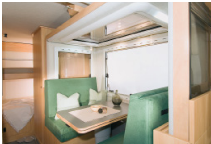
Der Wintergarten ein- und ausgefahren. Die Polster liegen im geschlossenen Zustand doppelt, werden dann auf die benötigten 170 Zentimeter ausgeklappt.
