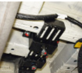
Gurtbockverstärkung am Boden.
