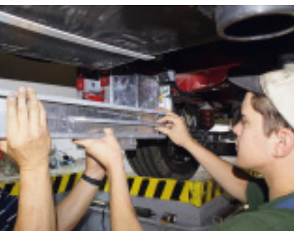
Die Rahmenverlängerung erweitert den roten Originalrahmen.
