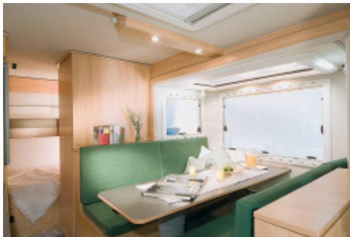
Der Wintergarten ein- und ausgefahren. Die Polster liegen im geschlossenen Zustand doppelt, werden dann auf die benötigten 170 Zentimeter ausgeklappt.
