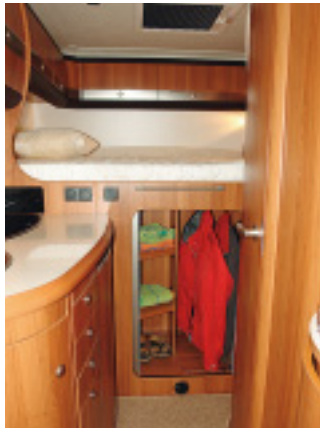
Gut durchdacht: Um Platz zu sparen, integriert Fendt den kompakten Kleiderschrank in den Bettkasten.
