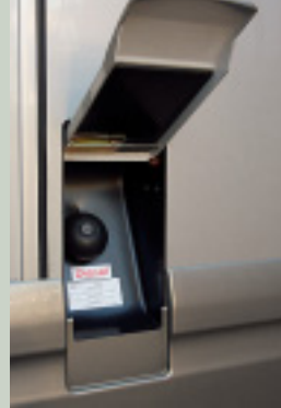
Der Tankverschluss versteckt sich beim V-Liner unter einer federunterstützten Klappe, der Gashauptkahn der Heizung in der Trittstufe zum Heckbett. Ein Bike mit schmalem oder gedrehtem Lenker passt in die mit Zurrseilen und -ösen ausgestattete, 74 cm breite und 117 cm hohe Garage.
