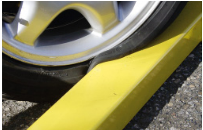
Killer Bordsteinkante und Co.: Ein Klemmschock schädigt die Reifenflanke.
