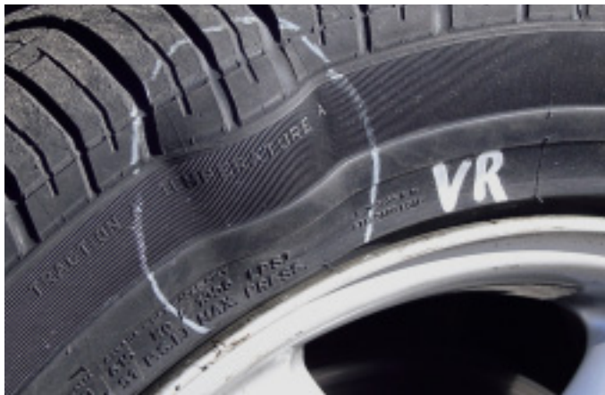
Sichtbare Beulen deuten auf einen defekten Reifenunterbau hin.
