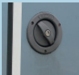
Dieseltropfen aus dem Standard-Tankverschluss des Globebus versauen die Karosserie. Heizung und Gaskasten schnüren der Garage den Hals zu. Nix für Fahrräder.
