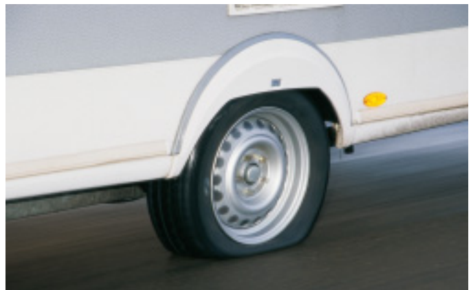
Fahren mit zu wenig Luft führt schnell zum Totalausfall – Reifenplatzer drohen!
