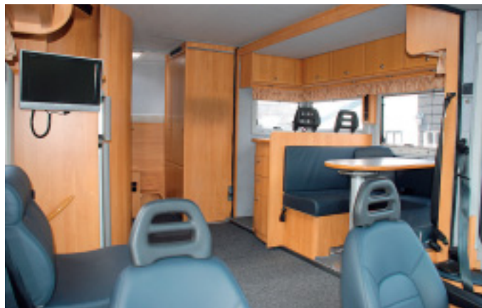
Ein Knopfdruck genügt, schon bewegen sich Küche und Sitzgruppe etwa einen Meter nach außen. Durch den Erker dringt viel Licht in den Innenraum.
