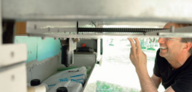
Der Spindelantrieb des Slide-Out arbeitet zuverlässig und ist leicht zugänglich.
