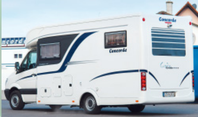
Auch das optisch reduzierte Heck aus hochwertigem Injektions-GfK wird dem Credo T bei seinem zweiten Anlauf helfen.
