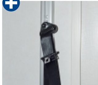
Die Gurtaufhängung in der Alu-Schiebne klebt an der Karosserie.
