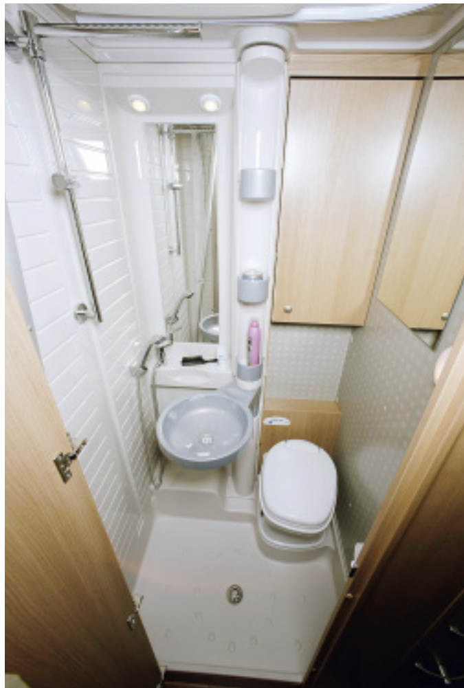
Gut durchdacht: Das Waschbecken lässt sich nach rechts über die Kassettentoilette schwenken. So schafft Bürstner Platz zum Duschen.
