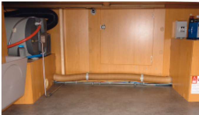
Licht und Schatten im Heckstauraum. Die Elektrik samt Batterie sowie die Truma Combi sind gut zugänglich, jedoch ist die Gasleitung stark gefährdet.
