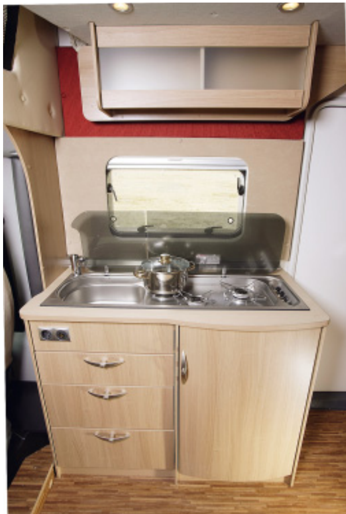
In der Schlange: Um die Küchenbreite schmal zu halten und dadurch die Durchgangsbreite im Gang zu erhöhen, werden die drei Flammen in Reihe montiert.
