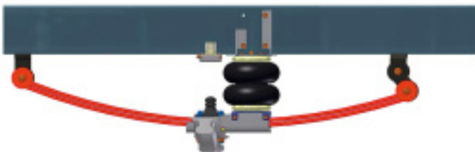
Nach dem Iveco Daily nun der MAN: Mit einer Luftfeder für die Vorderachse des MAN komplettiert Goldschmitt sein Angebot für Reisemobilchassis.
