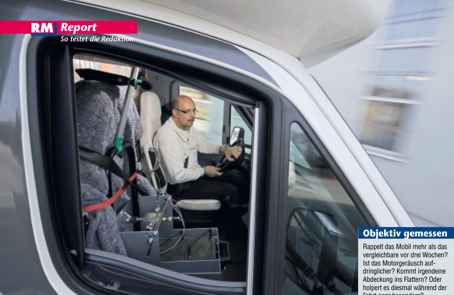
Am Alu-Dummy sind sowohl ein Mikrophon als auch ein dreiaxialer Beschleunigungssensor befestigt – ein stoßgesicherter Rechner zeichnet die Daten auf.
