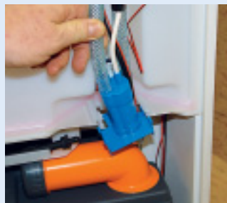
Im eingebauten Zustand ist die Pumpe der drehbaren Toilette schwerer zu erreichen, lässt sich aber tauschen.
