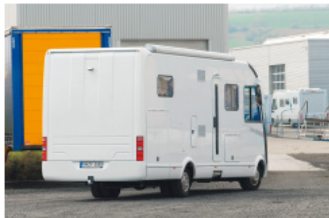
Das Gesicht des Flair verändert sich, das Heck ist komplett aus zweischaligem GfK. Auch neu: die Spiegel.
