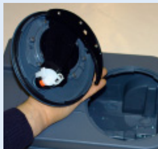
Wichtige Bauteile können über Bajonettverschlüsse oder Verschraubungen aus den Kassetten ausgebaut werden.
