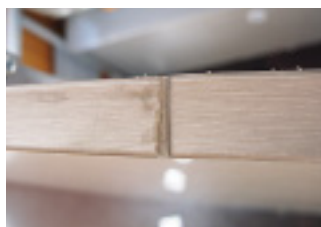
Kurzer Umleimer am YAMC-Tisch.
