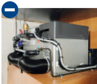
Die Alde-Compact-Heizung sollte in der Heckgarage besser geschützt sein.
