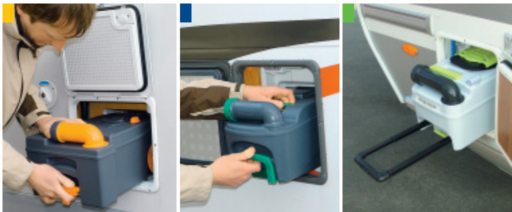
Die Abwasserkassette wird immer durch eine Serviceklappe in der Wohnwagenwand entnommen. Bei den Tanks von Thetford gelingt das sehr leicht. Die Kassette von Dometic verlangt hingegen etwas mehr Routine.
