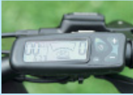
Top: kanadischer Bionx-Motor. Im Display aktiviert der Fahrer mit der Minustaste die Energierückgewinnung.
