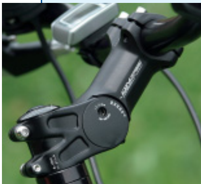
Mit verstellbaren Vorbauten lässt sich die Sitzposition variieren.
