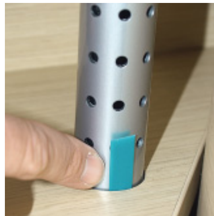
Die Löcher in den Trittstufen zum Heckbett sind im Adria sehr eng geraten. Plastikkeile mindern das Knarzen hier ebenso wie zwischen aneinander reibenden Möbeln im Chausson. Die Keile in verschiedenen Dicken lassen sich leicht zuschneiden.
