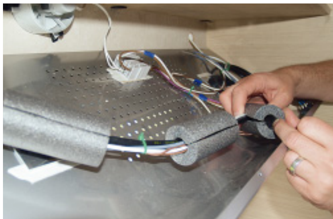
Kabelbinder fixieren lose Leitungen, die im Gehäuse der Dunstabzugshaube liegen. Stücke aus der Rohrummantelung verhindern Klappergeräusche. Der Bereich um die heißen Halogenlampen ist dabei jedoch tabu.
