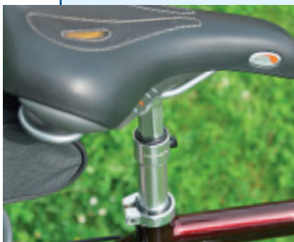
Die gefederte Sattelstütze im Koga lindert Stöße auf den Körper.
