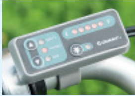
Top: kanadischer Bionx-Motor. Im Display aktiviert der Fahrer mit der Minustaste die Energierückgewinnung.
