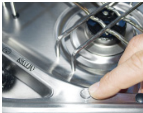
Bei einer klappernden Herdabdeckung justiert der Reisemobilist die Scharniere so, dass die Platte sauber aufliegt. Wichtig: Die Anschlagpuffer gehören hier nicht in den heißen Bereich.
