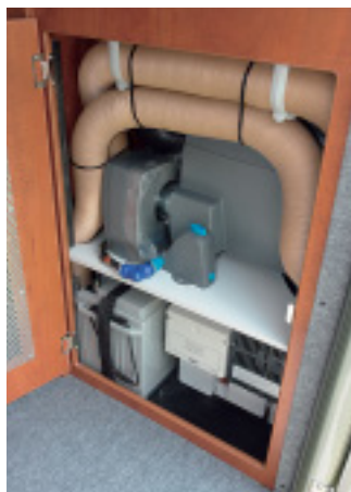
Gut erreichbar: Truma-Heizung und E-Zentrale stehen im Servicfach.
