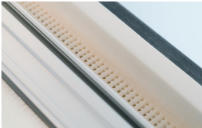
Kein Problem mit Kältebrücken: Seitz kann die Fenster in den Heizkreislauf integrieren. Durch kleine Luftlöcher wird Warmluft an der Scheibe entlanggeführt. Der kleine Lüfter versteckt sich im Rahmen.
