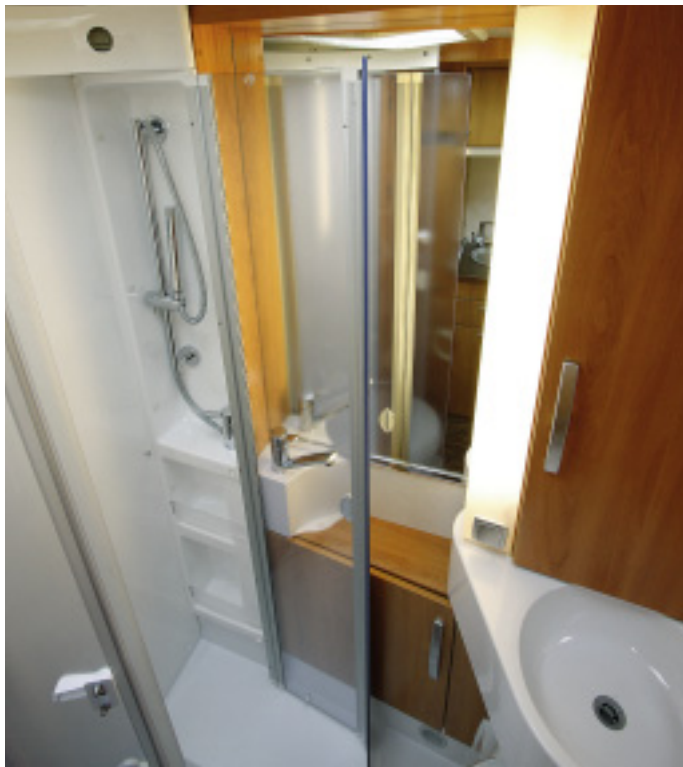
Einfallsreich: Dank wegklappbarem Waschbecken bleibt Platz für die Dusche.
