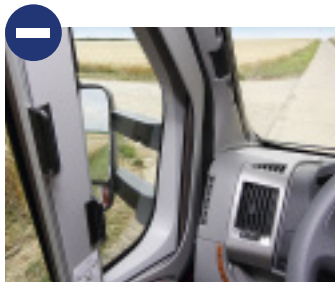
Der Rahmen für die Verdunklung versperrt die Sicht auf den Außenspiegel.
