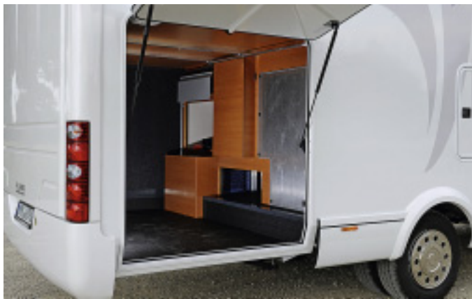
Beide Fahrzeuge verfügen über große Heckgaragen, die das Charisma wirkt etwas aufgeräumter. Das Bett stützt ein Alu-Sandwich mit RTM-Schaum-Isolierung. Niesmann setzt als Bettunterbau auf Holz mit einer Alu-Unterkonstruktion.
