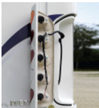
Zum Wechseln der Birnen klappen die Charisma-Rückleuchten aus.
