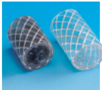
Ein Stück transparenter Schlauch zeigt den unerwünschten Biofilm.
