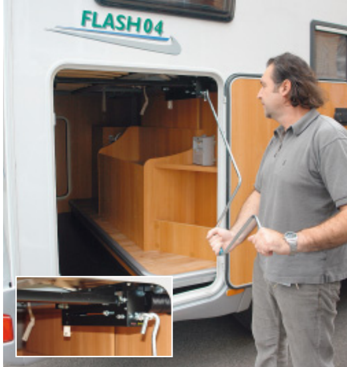
Serienmäßig: Das Heckbett ist höhenverstellbar. Dadurch vergrößert sich das Ladevolumen der darunter liegenden, beidseitig beladbaren Garage erheblich.
