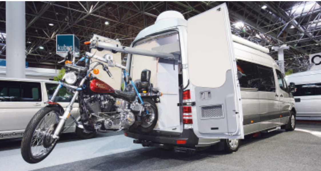
Ein ausklappbarer Kran mit elektrischer Seilwinde hebt das Motorrad an, das sich über Rollen im Kranausleger leicht verschieben lässt.
