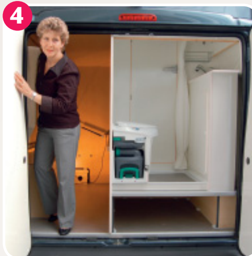
4 Schön zu sehen: der variable Cargoraum, der auch mit zwei Betten ausgestattet werden kann, und der Doppelboden.
