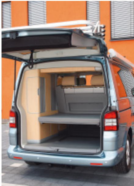
Um höhere Dinge zu transportieren, hebt das Bettbrett an. Regalschrank im Heck, Kleiderschrank mit Tresorfach, Durchlademöglichkeit seitlich.
