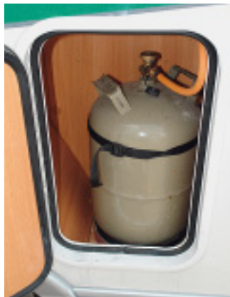
Sparsam: Die Gasanlage muss mit einer Elf-Kilo-Flasche auskommen.
