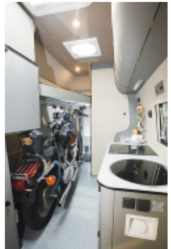
Ein ausklappbarer Kran mit elektrischer Seilwinde hebt das Motorrad an, das sich über Rollen im Kranausleger leicht verschieben lässt.
