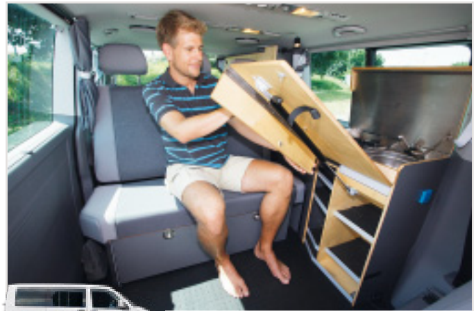
Genial: stabiler Schwenktisch als Schranktür, herausnehmbare, lange Schlafbank und LED-Leuchten im Seriendachhimmel (ohne Klappdach).
