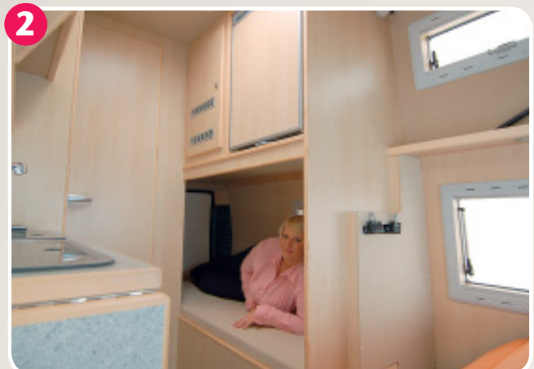
Der Einbauort für den Kühlschrank und die Heizung ist ungewöhnlich: Sie finden sich über Cargoraum und Stockbett. Die Küche steht gegenüber.
