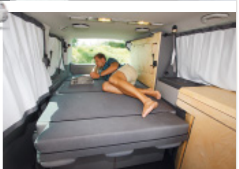
Genial: stabiler Schwenktisch als Schranktür, herausnehmbare, lange Schlafbank und LED-Leuchten im Seriendachhimmel (ohne Klappdach).
