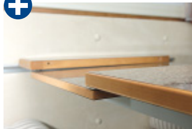
Brettgeschichte: Die Tischverlängerung kommt automatisch unter dem Tisch hervor.
