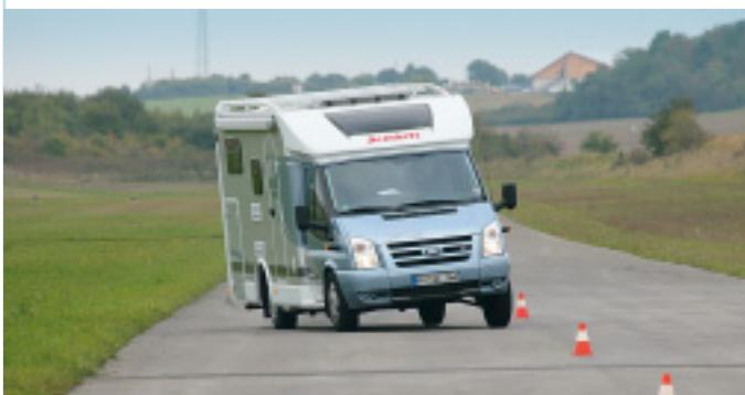
*Die Hinterachse des Transit geht rechts auf Block, führt das Mobil aber sicher in die Pylonengasse.*
