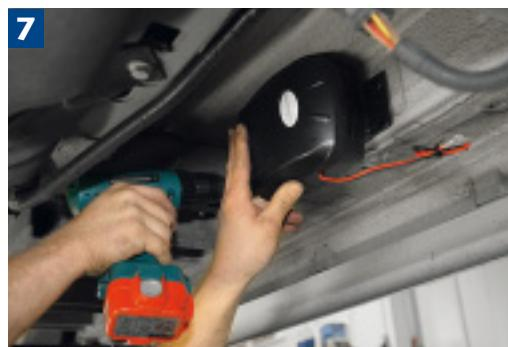
**3** Durch ein Bohrloch in der Trägerplatte wird der Luftbalg mit einer Mutter gesichert. Unten am Balg wurde zuvor das Halteprofil für den Achskörper verschraubt.
