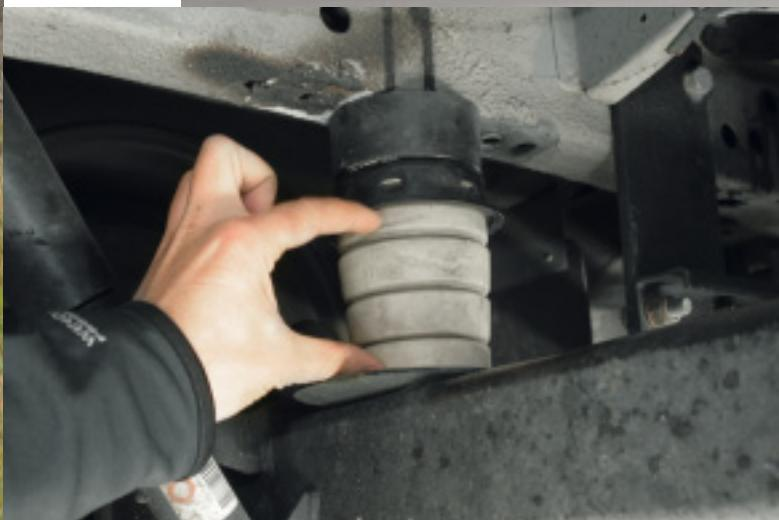
*Zusatzluftfedern heben das Heck, reduzieren die Aufsetzgefahr und erhöhen den Federweg. Mit Erfolg. Der Fahrkomfort profitiert. Doch beim Fahrverhalten zeigen sich nicht ausschließlich positive Effekte.*
