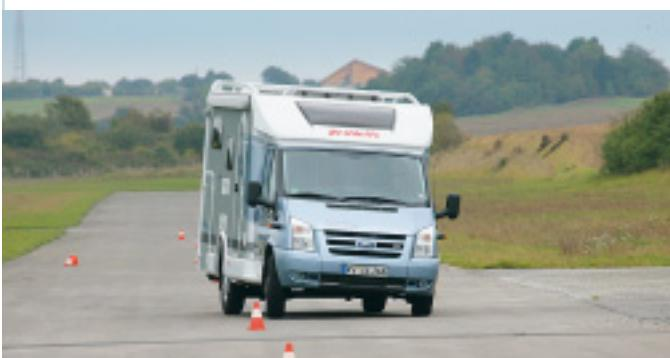
Das höhere Heck hält die Vorderachse trotz starkerer Seitenneigung am Boden. Das Mobil bleibt in Schwung.
