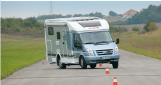
Durch den größeren Federweg schaukelt der Aufbau stärker. Das wirft die Hinterachse aus der Spur.
