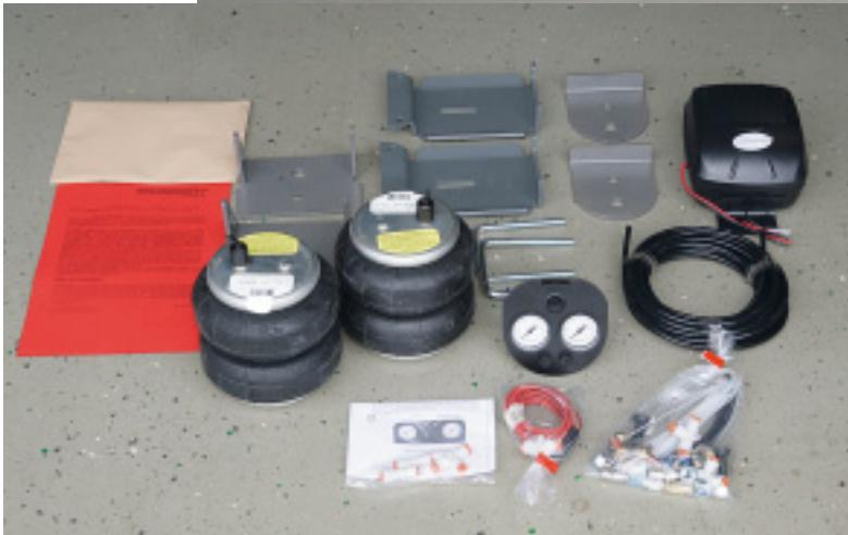
durch einen größeren Abstand zwischen Chassis und Achse geschaffen werden. Dies lässt sich am einfachsten durch den Einbau einer Zusatzluftfeder erreichen. Anstelle der massiven Gummipuffer montiert, drückt das Luftpolster in den Faltenbälgen das Heck des Mobil nach oben.
