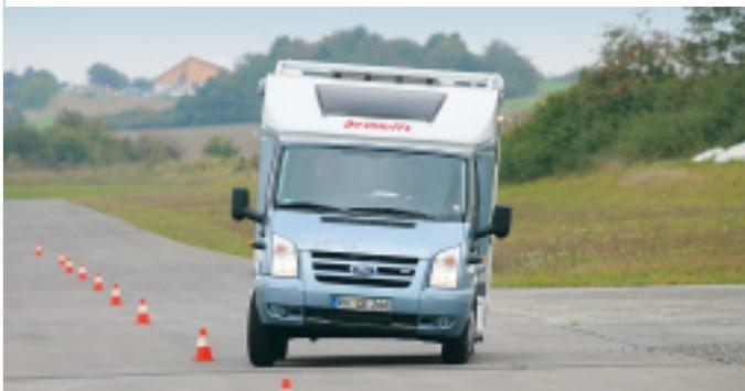
*Weil hinten der Federweg null ist, hebelt das schwere Heck das rechte Vorderrad aus. Folge: kein Vortrieb.*
