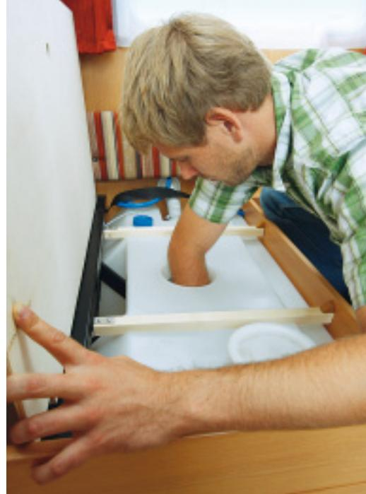
**Der Frischwassertank hat keinen Ablasshahn, weshalb ein schwer erreichbarer Stöpsel gezogen werden muss. Der unterflur montierte Abwassertank schlägt bei beladenem Auto des Öfteren hart auf. Dabei verbiegt sich die Abhängung. Der Tank selbst bleibt unversehrt.**
