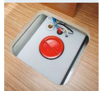
Platzsparend: Knaus baut den isolierten Frischwassertank unterflur ein.
