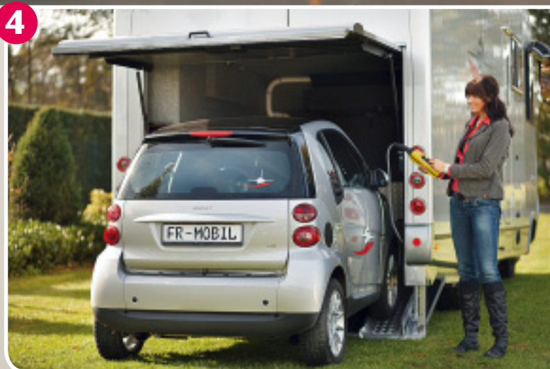
Zur Einfahrt sind keine Verlängerungsschienen notwendig. Das FR-Mobil lässt seinen Boden wie eine Plattform ab. Diese hebt den Smart ins Mobil.
