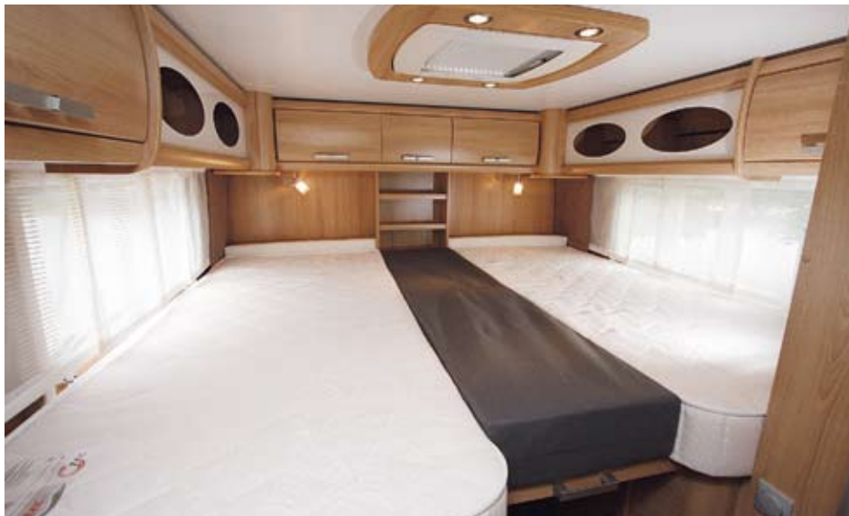
Die zwei Einzelbetten im Heck können mit Zusatzpolstern zur Spielwiese umgebaut werden. Zwei Schubladen finden sich am Fußende des rechten Betts. Platz verschenkt TEC durch ungeschickte Konstruktion in den Ecken der Hängeschränke. Stoßdämpfer helfen, das Bett hochzuklappen.
