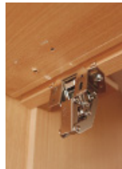
Am Dachschrank, an der Garderobe und am Deckel des Einzelsitzes rissen Schrauben aus dem weichen Sperrholz.
