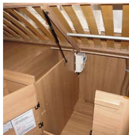
Die zwei Einzelbetten im Heck können mit Zusatzpolstern zur Spielwiese umgebaut werden. Zwei Schubladen finden sich am Fußende des rechten Betts. Platz verschenkt TEC durch ungeschickte Konstruktion in den Ecken der Hängeschränke. Stoßdämpfer helfen, das Bett hochzuklappen.
