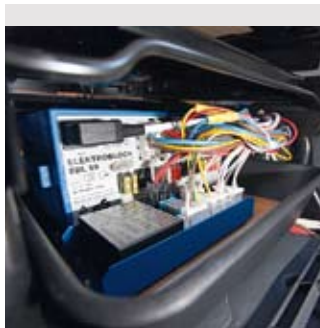
Gut erreichbar: Die Elektrozentrale des Viseo steht unter dem Beifahrersitz.
