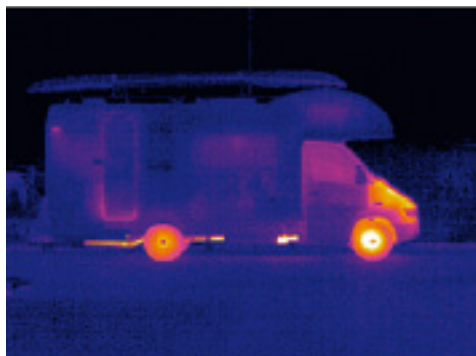
Die Bremsscheibe vorn hat bei der Fahrt die ganze Felge erwärmt. Zu erkennen sind der heiße Auspuff und der Motor.
