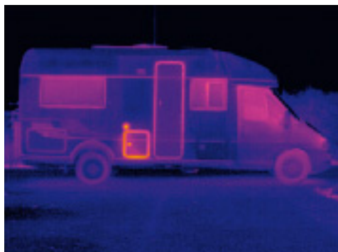
Deutlich sichtbar ist der Rahmen der Klappe, hinter der die Heizung sitzt. Hier geht Wärme verloren.
