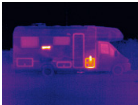
Der Kühlschrank ist nicht dicht eingepasst (helle Stelle links). Warmluft aus dem Innenraum strömt aus.
