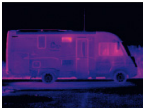
Gute Isolierung: Nur die Abluft des Kühlschranks entweicht durch die Belüftungsöffnung unterhalb der Markise.
