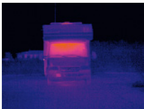
Über die Frontscheibe geht viel Energie verloren. Beim Alkovenmobil vermeidet das ein isoliertes Fahrerhaus.
