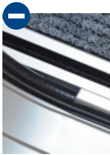
Offene Führungen sind schwer zu reinigen.
