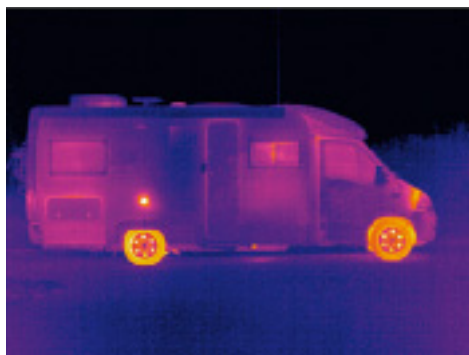
Dunkle Fensterrahmen auf dem Foto bedeuten, dass sie besser isolieren als die Rahmen der Klappen.
