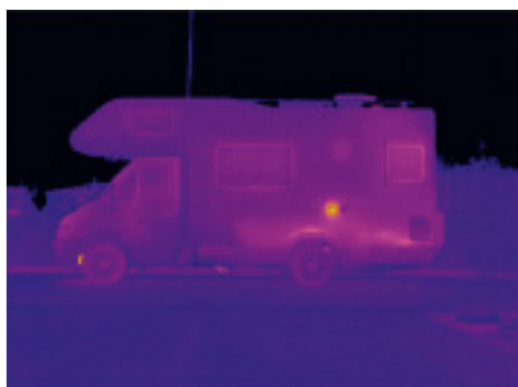
Die Heizung bläst warmes Abgas ins Freie. Die Wärme der Heizungsrohre durchdringt sogar die Wand.
