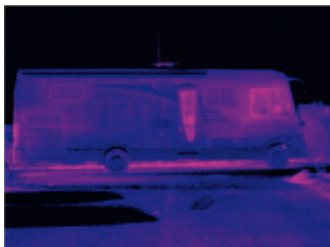
Dicke Isolierung und beste Klappen mit Rahmen ohne Kältebrücken wie bei diesem Integrierten sind ideal.
