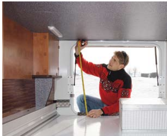
Der Blick auf die Straße ist dank des abfallenden Vorbaus exzellent. Der beheizte Heckstauraum ist mit soliden Zurrschienen ausgerüstet. Ein rutschhemmender Bodenbelag fehlt jedoch.
