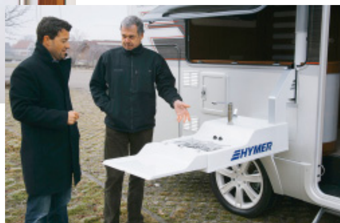
Aufgeräumt: Die schwenkbare Küche lässt sich drinnen wie draußen nutzen. Hymer-Entwickler Simon Leiprecht erklärt die Funktionen: Im Deckenfries können die Farben des Lichts frei gewählt werden, der Leuchtring an der Mischbatterie zeigt, ob warmes oder kaltes Wasser fließt.
