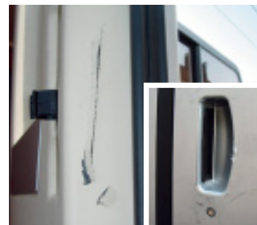
Diese Tür von Rhein Composite überstand den Einbruchversuch mit einem Brecheisen.
