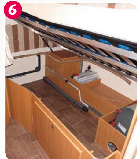
6 Unter dem Bett ist die Heizung montiert. Der Stauraum ist auch vom Heck aus zu erreichen.
