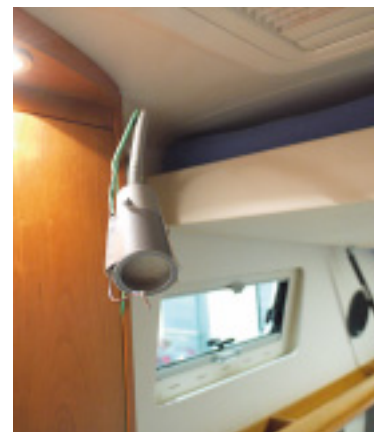
Verkabelt: Die Techniker von Webasto installierten im Kubus Meßfühler an allen interessanten Punkten im Fahrzeug (das Bett im Bild oben klappten die Techniker für die Messung nach unten).
