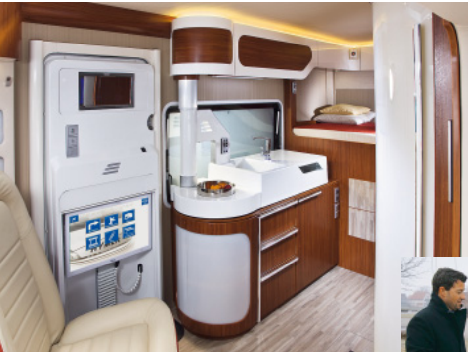
Aufgeräumt: Die schwenkbare Küche lässt sich drinnen wie draußen nutzen. Hymer-Entwickler Simon Leiprecht erklärt die Funktionen: Im Deckenfries können die Farben des Lichts frei gewählt werden, der Leuchtring an der Mischbatterie zeigt, ob warmes oder kaltes Wasser fließt.
