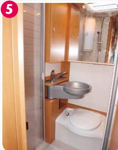
5 Das Waschbecken ist drehbar aufgehängt, kann zum Duschen also weggeschoben werden.
