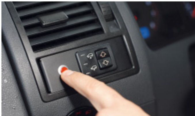
Der Schalter ändert sich, die Funktion bleibt: Der rote Knopf bringt den T5 binnen Sekunden in die Waagerechte. Die Räder können 16 cm Hub ausgleichen.
