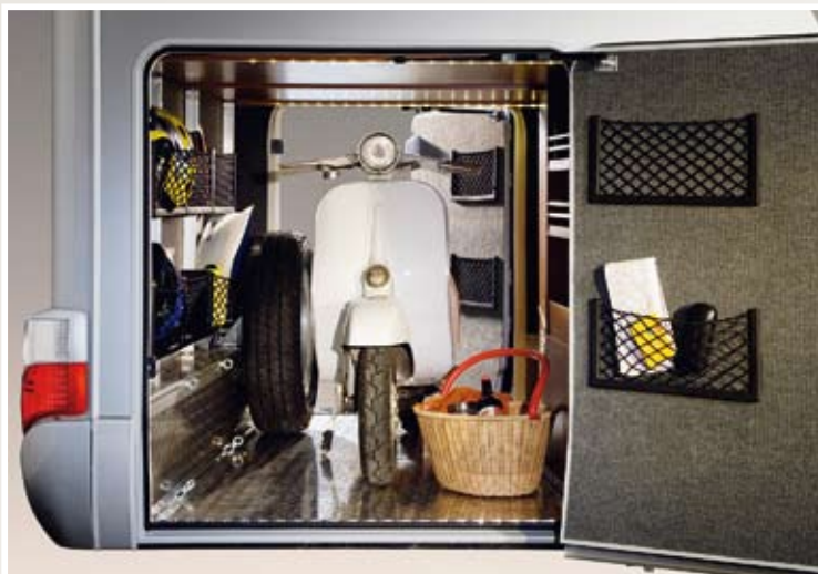
Zuladungsreserven von rund 840 Kilogramm erlauben die artgerechte Nutzung der mit Befestigungsschienen ausgestatteten Heckgarage.
