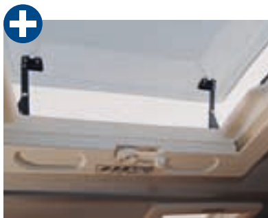
Das Dachfenster in der GfK-Hutze über dem Fahrerhaus sorgt für Licht und Luft.
