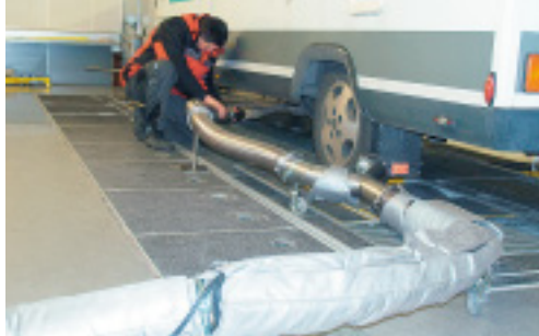
Ausgeklügeltes System: Schläuche transportieren Abgase und Partikel des Dieselmotors in Auffangsäcke.
