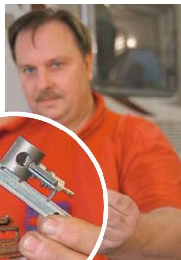
Häufige Attacken des Dampfstrahlers oder Lagerung in einer feuchten Garage setzen dem Brenner zu. Hier eindrucksvoll im direkten Vergleich: Alt gegen Neu.
