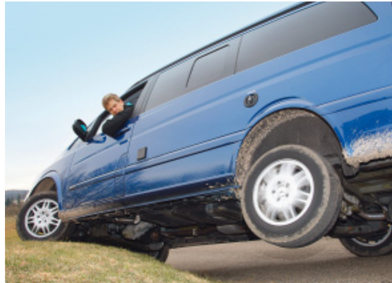
Auf einen Blick: Das Verteilergetriebe zum Antrieb der Vorderräder, die geringen Federwege und die wuchtigen Fahrwerksteile, die an der Bodenfreiheit nagen. Die Rampenwinkel vorn und hinten wachsen dank höherer Karosserie deutlich.
