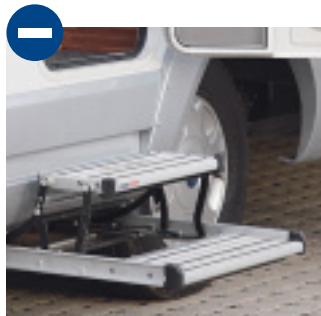
Die Trittstufe hängt im Spritzbereich, knarzt, rattert und friert folglich ein.
