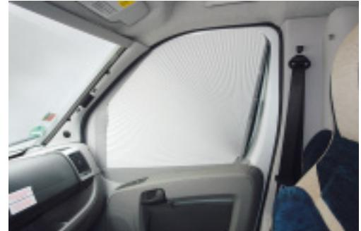
*Überarbeitete Details: Küchenfront mit Bügel und Faltverdunkelung für das Cockpit. Das Rollo behindert den Blick auf den Weitwinkelspiegel.*
