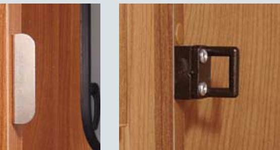
*Die Einrichtung des Carado ist solide und handwerklich sauber gefertigt. Allerdings ragen Metall- und Kunststoffschiebleche aus dem Rahmen der Badezimmertür in den Durchgang. Ebenso stehen sie aus den Rahmen der Schränke hervor. Beides birgt das Risiko, daran hängen zu bleiben.*
