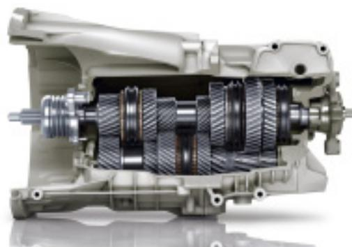
*Die neuen Schaltgetriebe sind länger übersetzt, sollen exakter rasten und verfügen über einen vierten Gang, der als effizienter Direktgang ausgelegt ist.*
