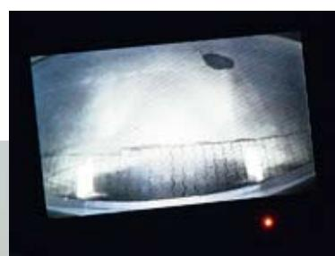
*Nachts sorgen 18 Infrarot-LEDs für eine gute Aussicht hinter das Fahrzeug.*
