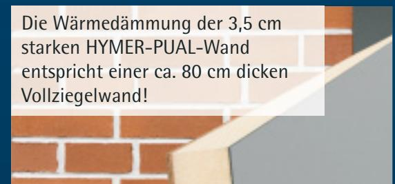
Der geschlossenporige und wasserundurchlässige PU-Schaum ist Garant für das energie sparende Heizkonzept. HYMER-PUAL-Technologie, vollverklebt und verwindungsresistent für die beste Isolation.
