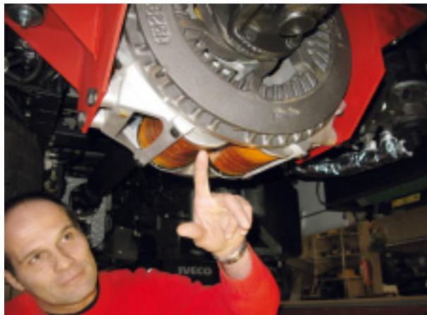
**Bremskraftverstärker: Jürgen Kloft sorgt mit dem Retarder für mehr Leistung und geringeren Materialverschleiß der Bremsanlage.**
