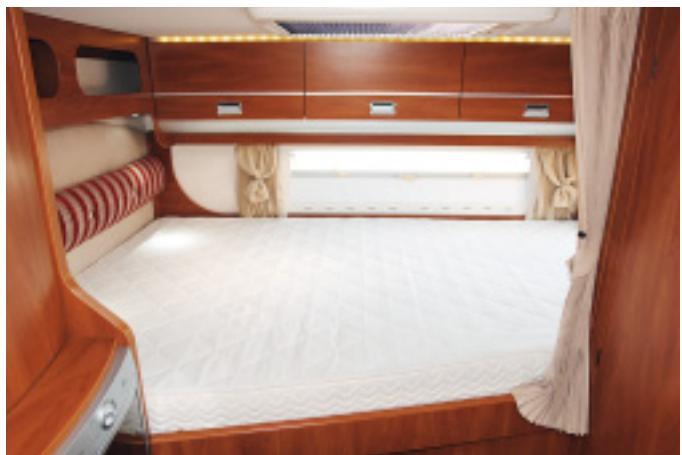
Der außen nahtlose Alkoven aus Glasfaser verstärktem Kunststoff (GfK) geizt weder mit Licht, Luft (auch warmer), noch Liegekomfort. Das ebenfalls bequeme Heckbett zollt dem großen Bad Tribut und wird am Fußende etwas schmäler.
