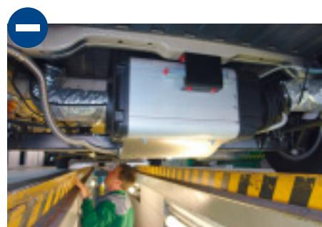
Der Abgaskamin der Heizung ist gefährdet. Er sitzt tiefer als die Hinterachse.
