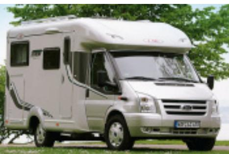
*Aus dem Breezer V 574 wird unter Verzicht auf den Einzelsitz neben der Tür und etwas Bettbreite im Fußbereich der sechs Meter kurze Breezer V 544.*
