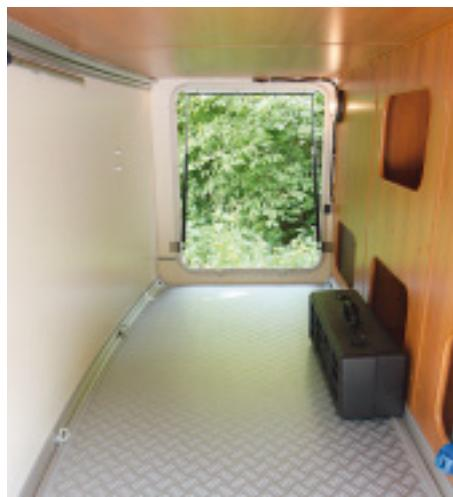
*Trotz Queensbett brauchbare Heckgarage mit stabilen Zurrschienen, offenen Staufächern und zwei Klappen. Zwei Lampen sorgen für Licht.*
