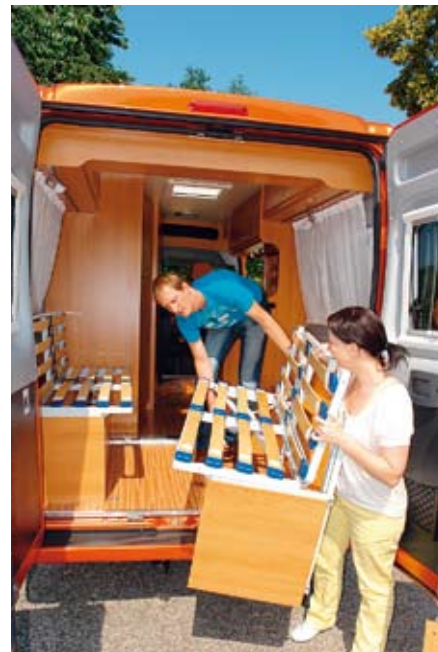
Doppelboden und Sitzbänke lassen sich aus dem Pössl entfernen. Hierzu sind vier Haken und vier Rändelmutter zu lösen. Beim Einbau müssen die Füße der Bänke in die Aufnahmen gleiten.
