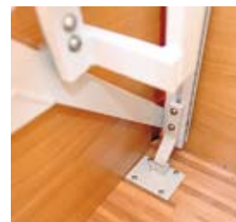
Doppelboden und Sitzbänke lassen sich aus dem Pössl entfernen. Hierzu sind vier Haken und vier Rändelmutter zu lösen. Beim Einbau müssen die Füße der Bänke in die Aufnahmen gleiten.
