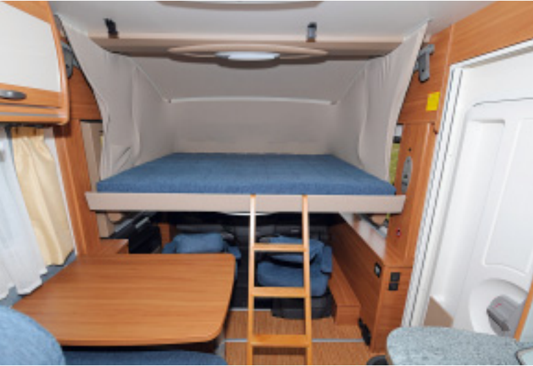
Das Hubbett verlangt viel Kraft beim Herunterschwenken. Dafür hängt es sehr stabil in seiner Halterung, klappert auch auf schlechten Straßen nicht.
