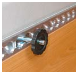
Doppelboden und Sitzbänke lassen sich aus dem Pössl entfernen. Hierzu sind vier Haken und vier Rändelmutter zu lösen. Beim Einbau müssen die Füße der Bänke in die Aufnahmen gleiten.
