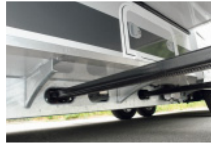
Der zusammen mit Al-Ko entwickelte Antrieb des Erkers kommt platz sparend im Al-Ko-Chassis unter.
