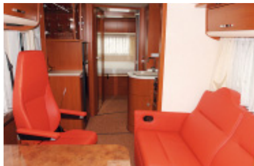
Der Slide-Out verbreitert den Bereich der Sitzgruppe um 60 Zentimeter.
