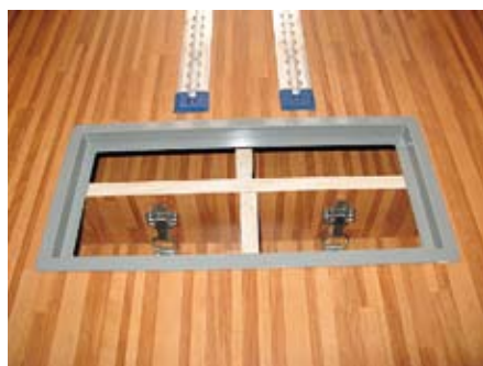
Doppelboden und Sitzbänke lassen sich aus dem Pössl entfernen. Hierzu sind vier Haken und vier Rändelmutter zu lösen. Beim Einbau müssen die Füße der Bänke in die Aufnahmen gleiten.
