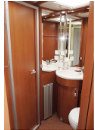
Mit der schwenkbaren Toilettenwand entsteht ein durchgehendes, nach vorn hin abgetrenntes Bad.
