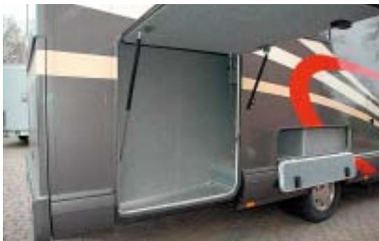
Ein seitlicher Stauraum neben dem Mini ist weiterhin über die ursprüngliche Stauklappe der Heckgarage zugänglich.
