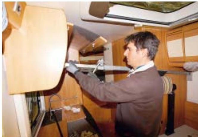
Wand müssen sie das Gegenlager pfleglich behandeln. Dort legen sie dämpfendes Material unter, das die Kräfte auf eine größere Fläche verteilt, um Dellen zu vermeiden.
