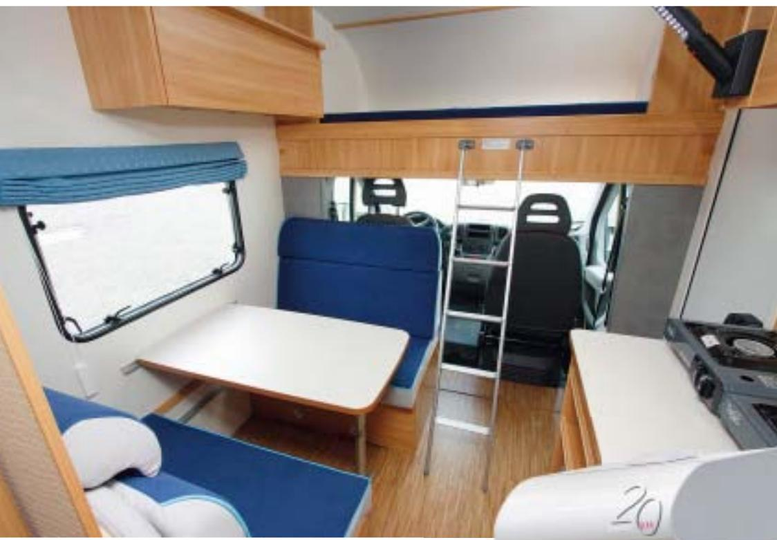
*Das Alkovenbett misst 2,11 mal 1,41 Meter und verfügt über eine lichte Höhe von bis zu 70 Zentimetern.*
