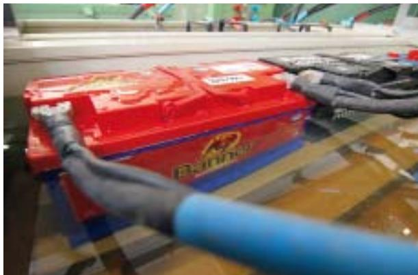
*Bei konstant 25 Grad durchlaufen die Batterien im Wasserbad einen Großteil des Tests.*
