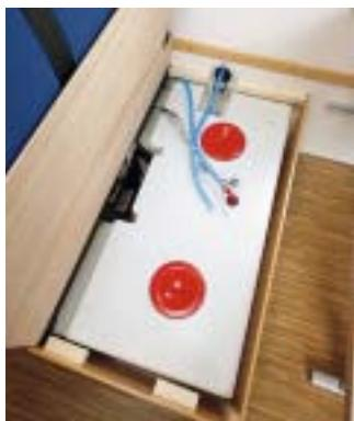
*Oben: Der 2,30 Meter breite Aufbau aus Alu-Sandwich erlaubt den Einbau einer großen, umbaubaren Viererdinette. In ihrem Unterbau lagern exklusiv fürs Jubi-Mobil 100 Liter Frischwasser.*
