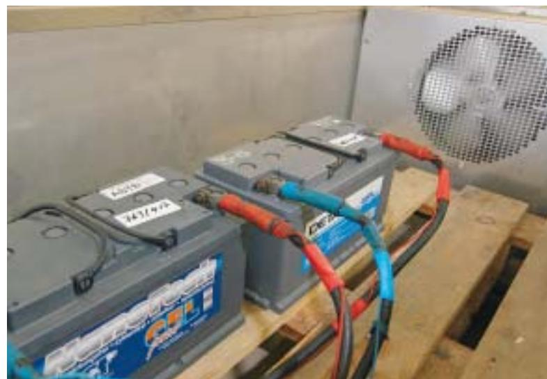
**Kältetest:** In der „Gefriertruhe“ müssen die Batterien beweisen, ob sie die geforderte Laufzeit des Testprofils auch bei 0 Grad stemmen und wie viel Energie sie bereitwillig bei diesen frostigen Temperaturen liefern.
