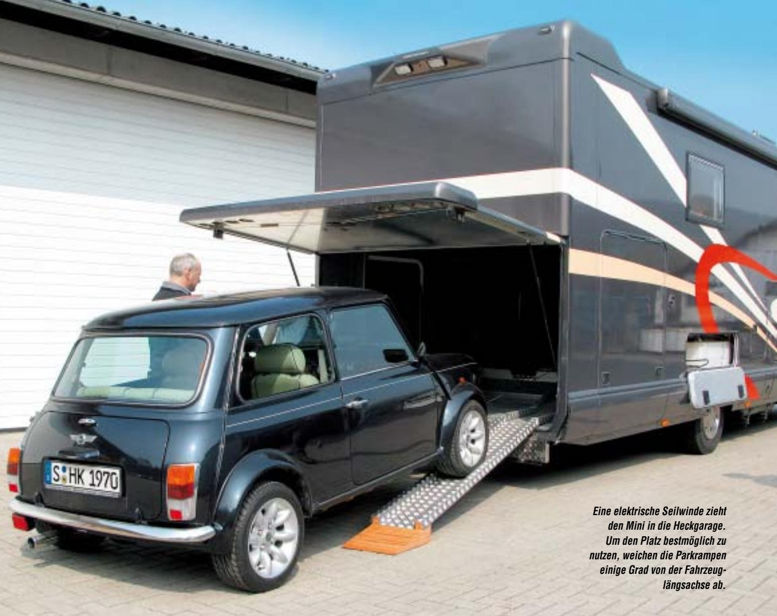
Eine elektrische Seilwinde zieht den Mini in die Heckgarage. Um den Platz bestmöglich zu nutzen, weichen die Parkrampen einige Grad von der Fahrzeuglängsachse ab.
