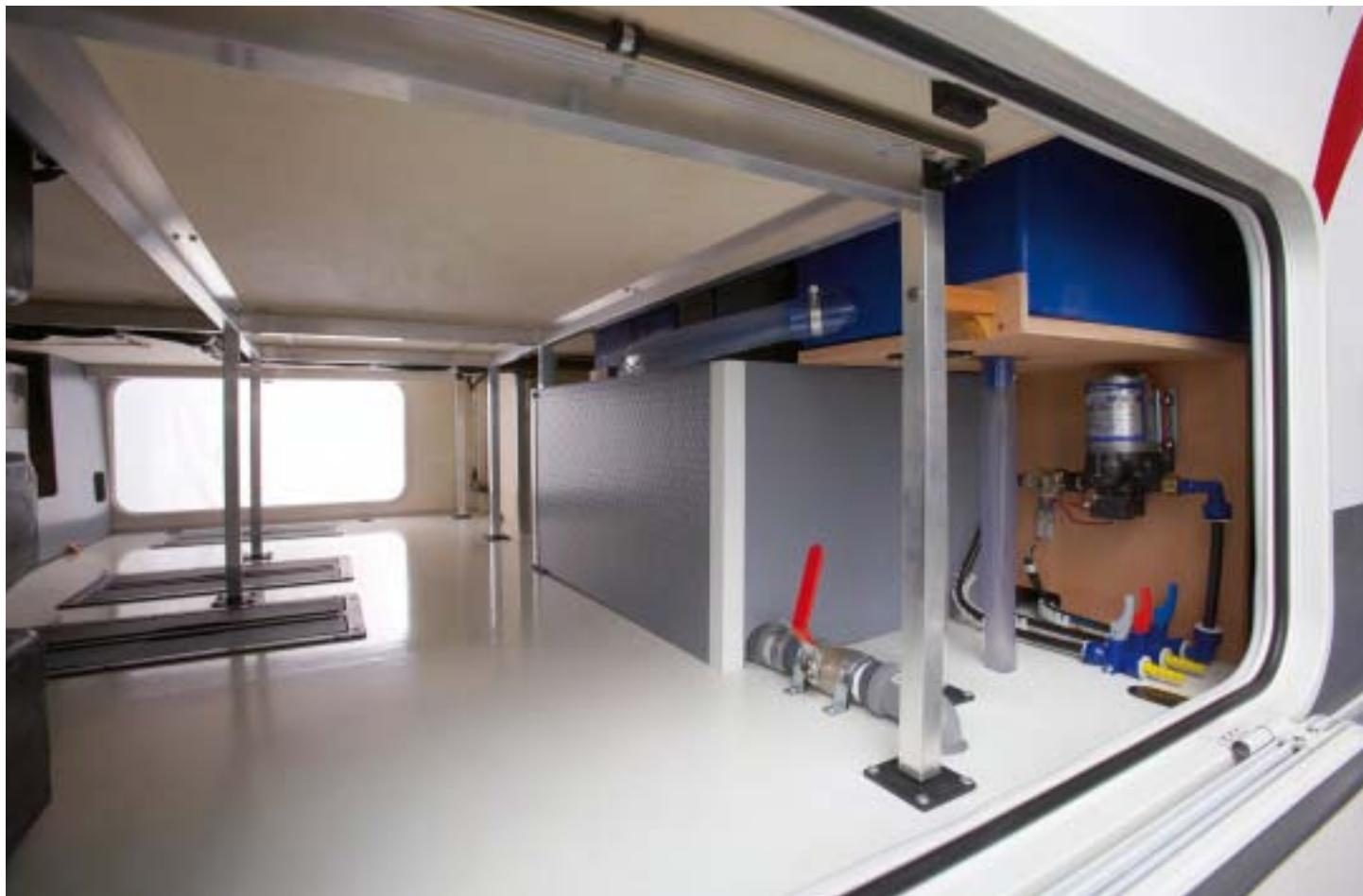
**Doppelboden:** Manch einer bezeichnet ja schon eine ausziehbare Schublade als Doppelboden. Bei Euramobil können Sie sicher sein, einen durchgehenden „Keller“ mit maximalen Stauraummöglichkeiten und hervorragenden Wintereigenschaften zu bekommen. Mit isoliertem Ober- und Unterboden, mit Heizung,
