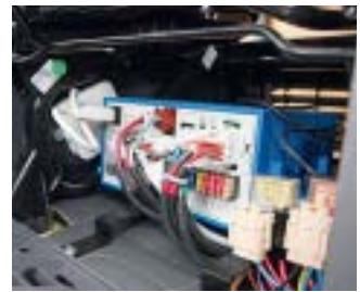
*Oben: Elektrozentrale unter dem Beifahrersitz. Das Ladegerät spendiert Schaudt. Es füllt die 80-Ah-Gelbatterie von Banner.*
