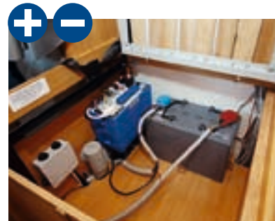
Positiv: E-Zentrale gebündelt montiert. Negativ: Sie steht im Stauraum.
