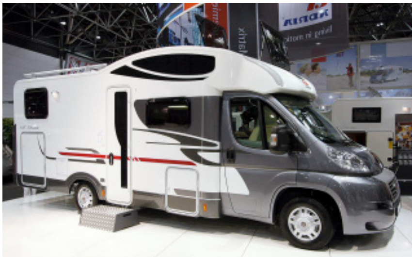
Eine im Mittelbereich erhöhte Hutze schafft beim Adria Matrix Platz für das Hubbett unter dem Dach.
