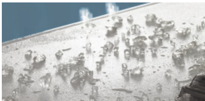
PPG Industries lässt sein wärmedämmendes und schlagdämpfendes Hagelschutzpolster von spezialisierten Lackierereien aufsprühen.
