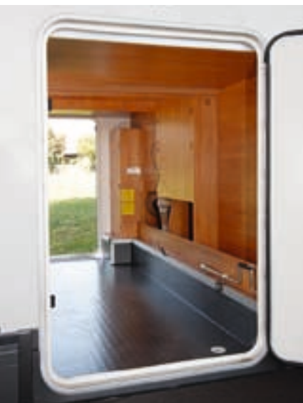
Adria stattet die voluminöse Heckgarage des Coral mit Zurrösen und zwei großen Ladeluken aus.
