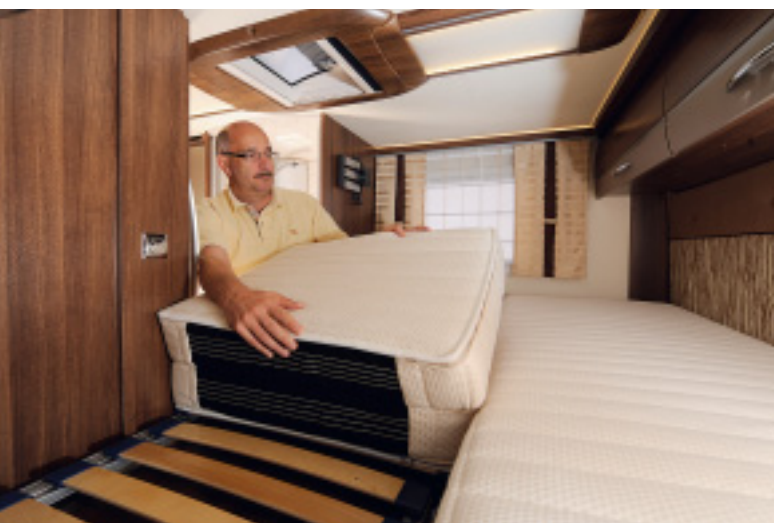
Wer zum Lesen seinen Kopf höher legen möchte, kann den Lattenrost des Heckbetts über der Garage auf einer Seite hochstellen.
