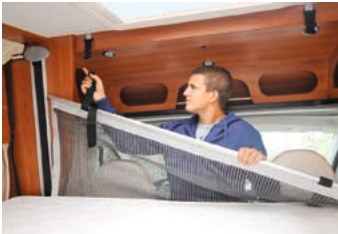
Nach vorn und nach hinten sind am zentral angeordneten, elektrisch in der Höhe verstellbaren Hubbett Absturzsicherungen montiert.
