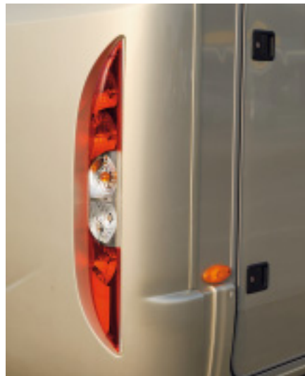
Die Rückwand des Elegance besteht aus einem Stück. Die Leuchten stehen weit über und verlangen deshalb beim Rangieren besondere Aufmerksamkeit.
