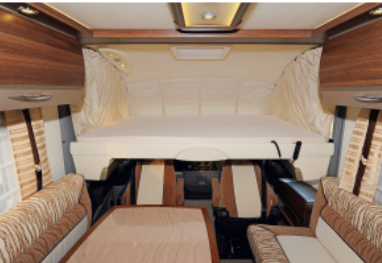
Auf Knopfdruck senkt sich das serienmäßig eingebaute, elektrische Hubbett herab. Auch die Kaltschaummatratzen beider Betten kosten keinen Aufpreis.
