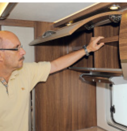
Die Möbel sind mit dunkler Folie im Dekor Mooreiche überzogen. Die Klappen hängen an stabilen Scharnieren, die Regalbretter sind in der Höhe verstellbar.
