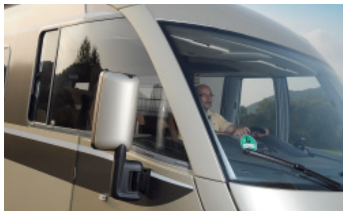
Die Sicht auf die Spiegel ist sehr gut. Das rechte Außenfenster kommt ohne Strebe aus und der Türrahmen links sitzt außerhalb des Sichtfeldes.
