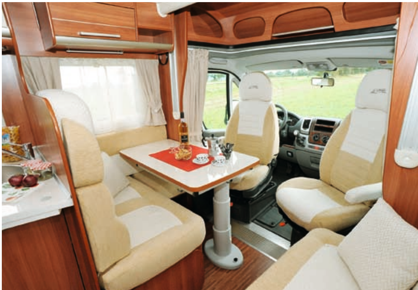
Der Tisch ruht auf einem soliden, höhenverstellbaren Fuß und kann nach dem Lösen der Rändelschrauben in alle Richtungen verschoben werden.
