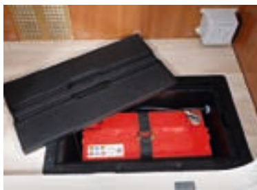
Gut gemacht: Die Bordbatterie findet ihren Platz im Servicefach des Außenstauraums, die Schließbleche der Möbel sind aus Hartplastik.
