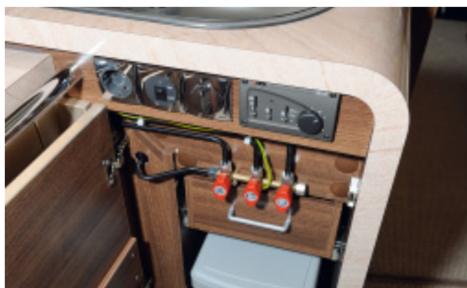
Hinter einer selbst arretierenden Klappe liegen die Gasbsperrhähne versteckt. Die kleine Schublade darunter nutzt den Raum über dem Müllsammelr.
