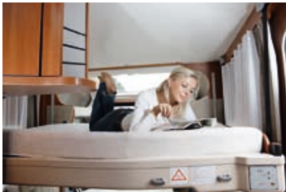
Elektrik-Trick: Gut schlafen lässt es sich im absenkbaren und mit hölzernem Lattenrost versehenen Hubbett des Teilintegrierten.
