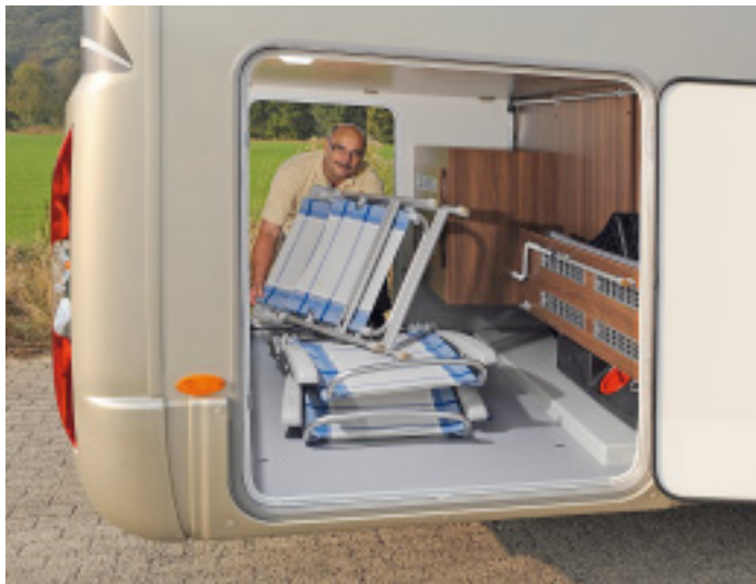
Die Heckgarage ist riesig. 228 Zentimeter tief, 118 Zentimeter hoch und 156 Zentimeter breit, fasst sie locker neben vier Rädern auch noch Campingstühle.
