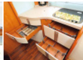
Die Schubladen sind mit einem verstellbaren Einteilungssystem ausgerüstet. Sie gleiten ausgezeichnet in ihren Schienen und haben einen Endeinzug.
