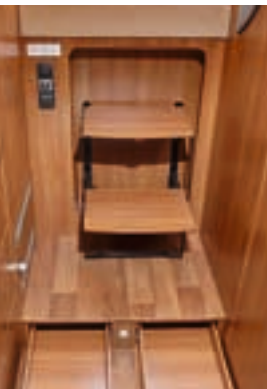
Trickreich: Die abklappbaren Stufen des Heckbetts integriert Dethleffs gekonnt in dessen Front.
