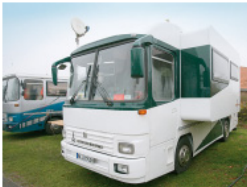
Stefan Schulz hat den Slideout nahtlos angepasst – der Erker am Magirus-Deutz-Reisebus sieht aus wie original.
