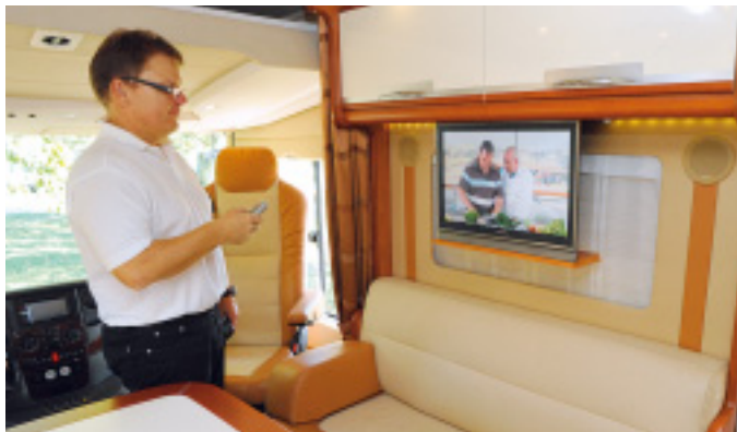
Der Flachbildschirm gleitet motorbetrieben hinter den Hängeschränken hervor. Links und rechts neben dem Bildschirm sind Lautsprecher eingelassen.
