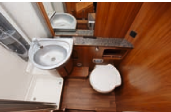
Elegante Lösung: Das Waschbecken lässt sich zur Seite schieben um mehr Platz im Bad zu schaffen.
