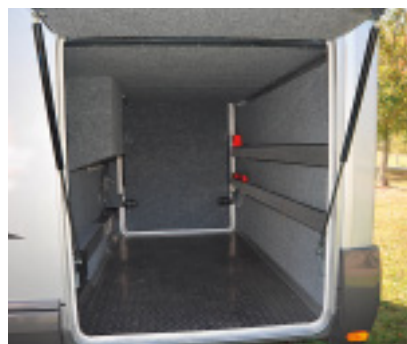
Die Heckgarage ist mit Filz ausgeschlagen. Die Elektrozentrale sitzt in einem separaten Fach.
