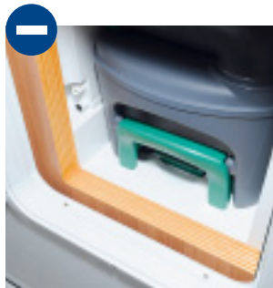
Eine Dichtung zwischen der Holzverblendung und der Wand fehlt.
