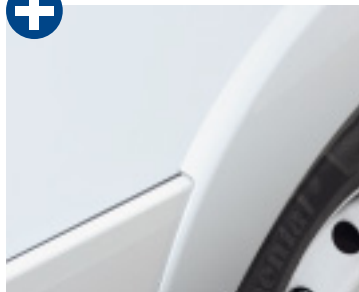
Die Alu-Seitenschürzen sind stabil. Eine Dichtung trennt sie von der Karosserie.
