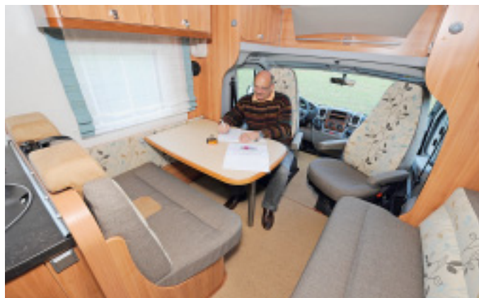
Das 110 Zentimeter breite Sofa hinter dem Beifahrersitz lässt sich zusammen mit dem abgesenkten Tisch und Zusatzpolstern mit wenigen Handgriffen zu einem weiteren Bett umbauen.
