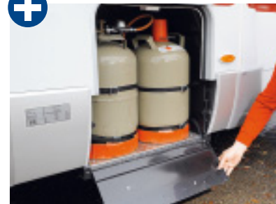
Keine Kante behindert das Wechseln der Gasflaschen.
