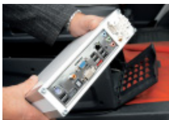
Halten die Fäden des Stick-Profis zusammen: Zwei Netco-Rechner, die für Kommunikation, Navigation und Unterhaltung verantwortlich sind.
