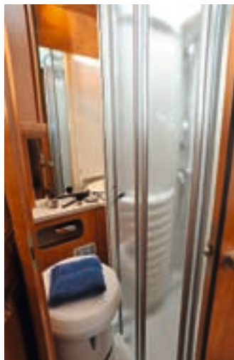
Der Umbau zur Dusche: Die seitliche Wand wird als Schutz vor das Waschbecken geschwenkt und die Schiebetür vor die verbliebene Öffnung gezogen.
