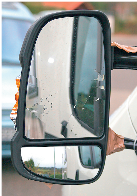
Ausgangslage: Gesplittertes Spiegelglas behindert den Blick neben und hinter das Fahrzeug.
