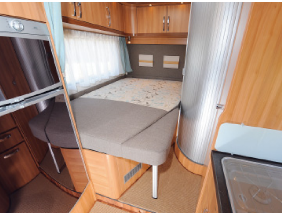
Eine unter dem Bett hochklappbare Ecke erweitert die Liegefläche. Der Flachbildschirm kann dank der Schiene und des Klappmechanismus von der Sitzgruppe und allen Betten aus gesehen werden.
