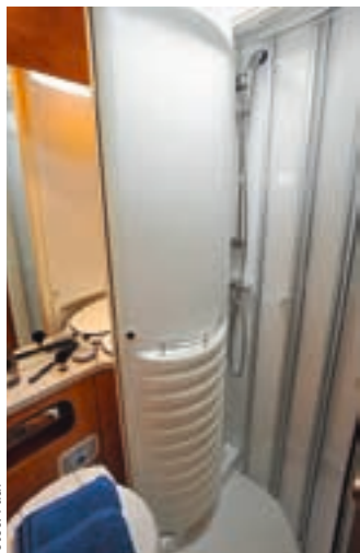
Der Umbau zur Dusche: Die seitliche Wand wird als Schutz vor das Waschbecken geschwenkt und die Schiebetür vor die verbliebene Öffnung gezogen.
