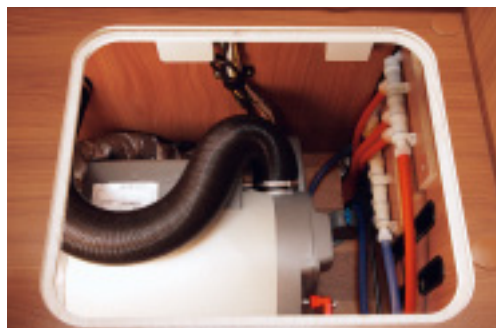
Gut erreichbar: Die Truma-Heizung nebst Ablasshahn für den Boiler baut Dethleffs im Unterschrank des Kleiderschranks ein. Entfernt man die Bodenklappe, kommt man problemlos dran.
