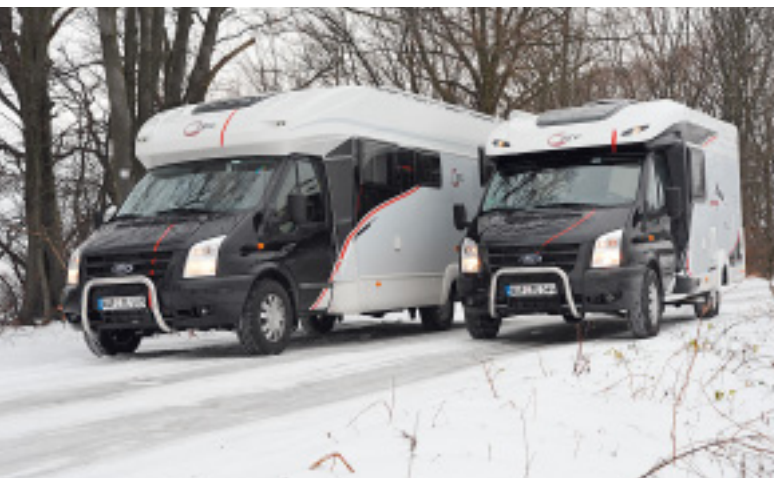
Die beiden Mobile ähneln sich gewaltig. Nur hat der TEC Crosstec (links) Allradantrieb, der Van auf der rechten Seite muss mit Frontantrieb auskommen.
