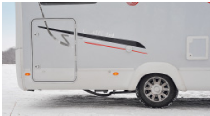
Das ungeschützte Heck des TEC Crosstec 4x4 ragt 2,25 Meter über die Hinterachse hinaus. Deshalb sind Fahrten in unwegsames Gelände tabu.
