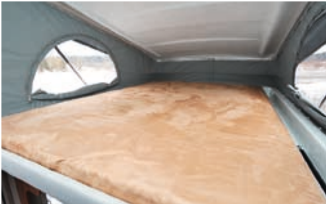
Ganz neues Raumgefühl ergibt sich durch das hochklappbare Dach. Dabei entspricht der Grundriss exakt dem Mobil ohne Klappdach.
