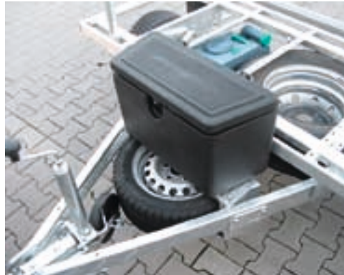
Achsposition, Deichsellänge und Höhe der Anhängerkupplung lassen sich per Lochbild anpassen.
