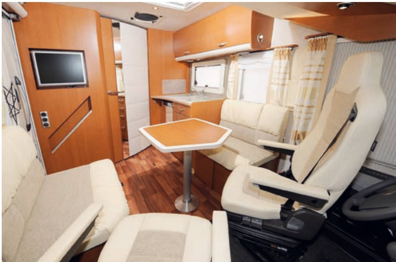
Die beiden drehbaren Frontsitze haben in der Höhe einen großen Verstellbereich. Damit lassen sie sich ohne Probleme an die gewünschte Position des Chauffeurs während der Fahrt und an die Höhe der beiden Einzelsitze mitsamt dem Esstisch anpassen.
