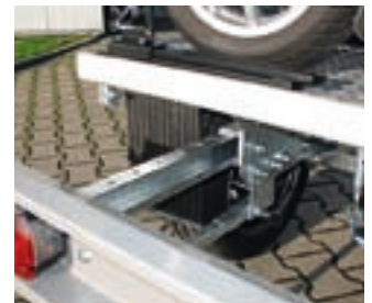
Auf der ausziehbaren Stoßstange reisen bei Bedarf zwei Fahrräder mit. Und der Hänger lässt sich aufstellen.
