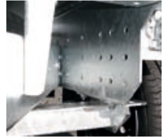
Achsposition, Deichsellänge und Höhe der Anhängerkupplung lassen sich per Lochbild anpassen.
