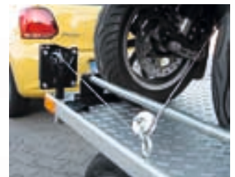
In den Vierkantaufnahmen finden Ladebordwände oder eine Seilwinde (99 Euro) Platz, die beim Aufladen schwerer Zwei- oder Dreiräder helfen.
