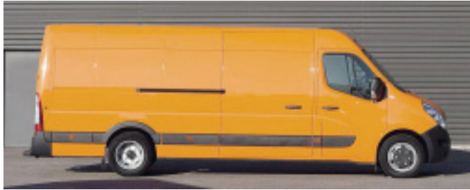
Unter der längsten verfügbaren Karosserie dieses Master verbirgt sich das neue Zwillingssreifen-Fahrgestell mit 4,5 Tonnen zulässiger Gesamtmasse.
