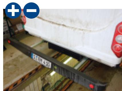
Ausziehbare Stoßstange mit 200 Kilo Tragkraft. Heck-Sicke sammelt Dreck.
