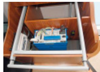
**Gut gelöst:** Die Elektrozentrale mit Ladegerät und Sicherungskasten steht gut erreichbar unter der Längsbank des Polaris.
