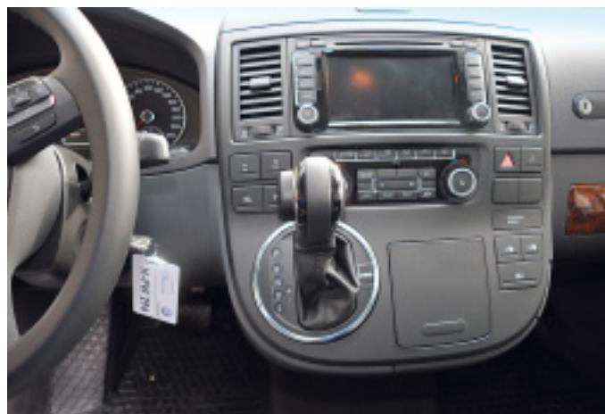
Haben die Vorderräder keinen Grip mehr, schaltet die Steuerelektronik blitzschnell den Antrieb der Hinterachse zu. Der Schaltknopf des DSG-Getriebes ermöglicht das Wählen der Gänge auch von Hand.
