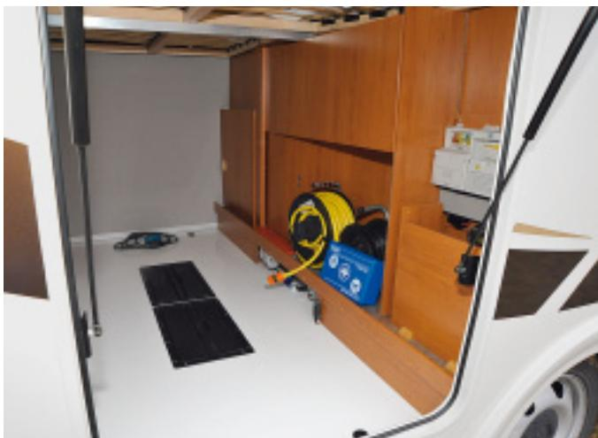
Zwei Kästen sind in den Boden der Heckgarage eingelassen. Sie nehmen die Wohnraumbatterien auf. Was allerdings fehlt, sind Verzurrösen.
