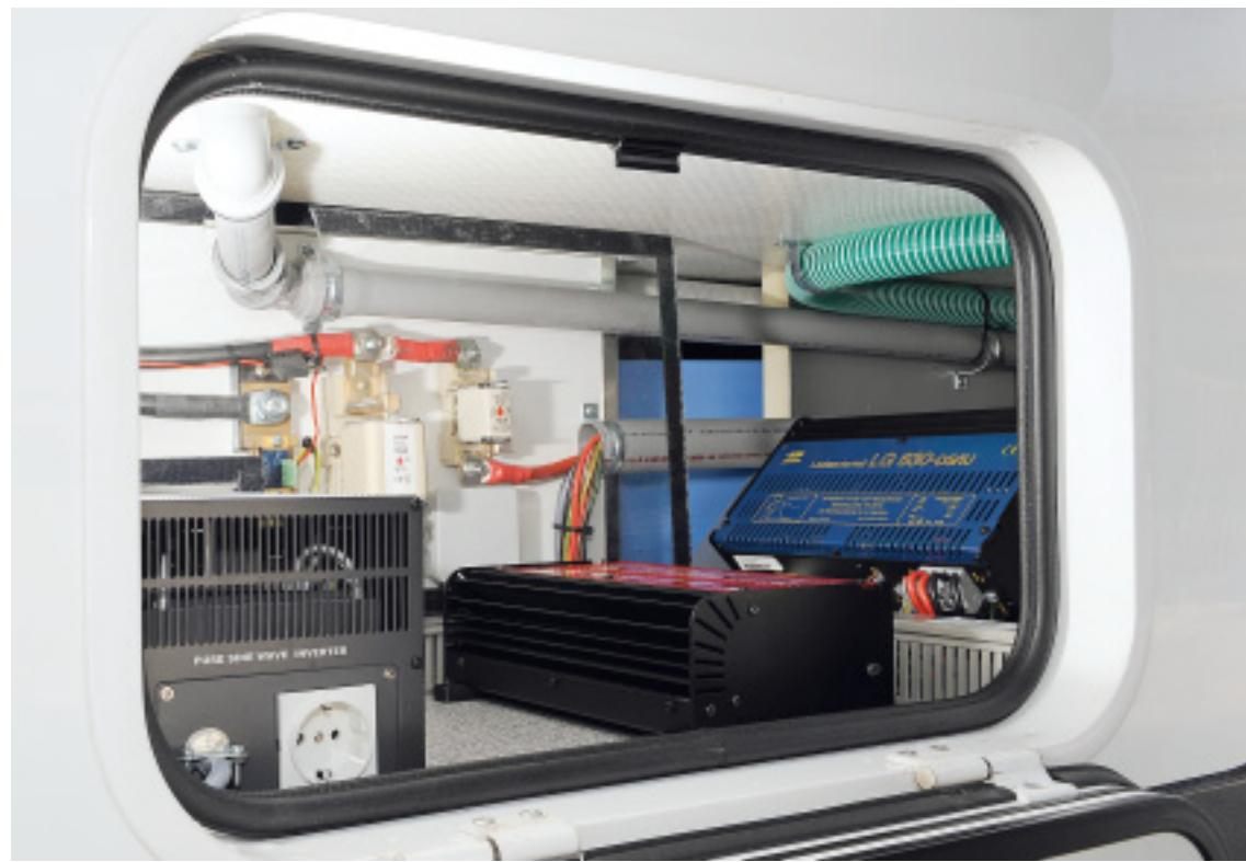
*Perfekte Gas-, Wasser- und Elektroinstallationen im doppelten Boden treiben dem Fachmann Freudentränen in die Augen. Allerdings wirken sich zusätzliche Einbauten wie Fäkalientank, 230-Volt-Transformator (oben), Außendusche (rechts unten) und Klimaanlage (links unten) negativ auf den Stauraum aus.*
