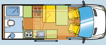
**Maße und Gewichte** (L x B x H): 591 x 199 x 315 cm, Radstand: 366 cm, zul. Gesamtmasse: 3.500 kg, Masse in fahrb. Zustand: 2.800 kg, Anhängelast gebremst 2.000 kg, ungebremst 750 kg.
