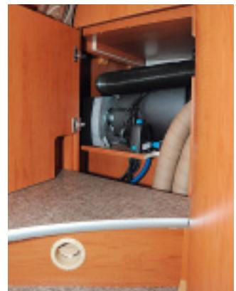
**Die Heizung montiert Karmann zusammen mit dem Ablassventil unter dem Kleiderschrank.**
