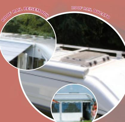
**ROOF RAIL Ducato**, spezielle Reling ab Modell 06 (für langen und kurzen Radstand), die ideale Ergänzung zur Markise.
