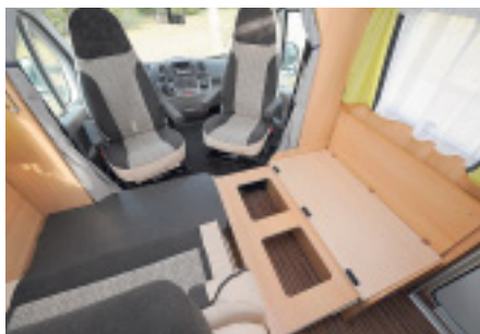
Für 205 Euro liefert Sunlight die Sitzgruppe in einer umbaubaren Version. Dann lässt sich der Tisch absenken und aus der Seitensitzbank eine Verbreiterung ausziehen. Nun einfach mit den Sperrholzdeckeln eine glatte Oberfläche schaffen und die Polster auflegen. So entsteht ein 210 mal 115 Zentimeter großes Bett.
