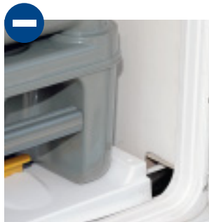
Der Toilettenschacht ist nicht abgedichtet – es drohen Wasserschäden.
