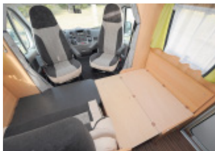
Für 205 Euro liefert Sunlight die Sitzgruppe in einer umbaubaren Version. Dann lässt sich der Tisch absenken und aus der Seitensitzbank eine Verbreiterung ausziehen. Nun einfach mit den Sperrholzdeckeln eine glatte Oberfläche schaffen und die Polster auflegen. So entsteht ein 210 mal 115 Zentimeter großes Bett.
