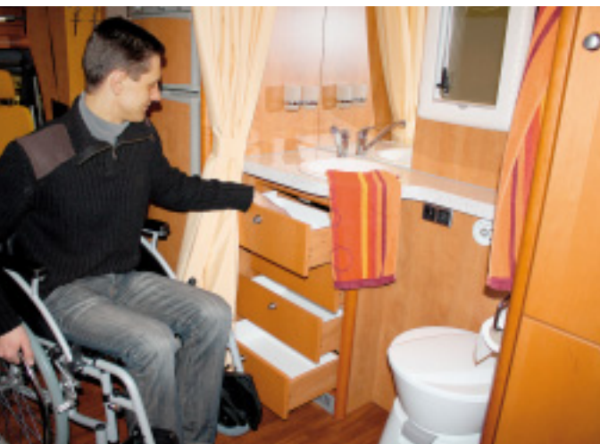
Auf sich allein gestellt: Tiefer gesetzte Schubladen und Fächer erleichtern den mobilen Alltag des Rolli-Fahrers.
