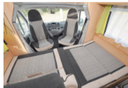
Für 205 Euro liefert Sunlight die Sitzgruppe in einer umbaubaren Version. Dann lässt sich der Tisch absenken und aus der Seitensitzbank eine Verbreiterung ausziehen. Nun einfach mit den Sperrholzdeckeln eine glatte Oberfläche schaffen und die Polster auflegen. So entsteht ein 210 mal 115 Zentimeter großes Bett.
