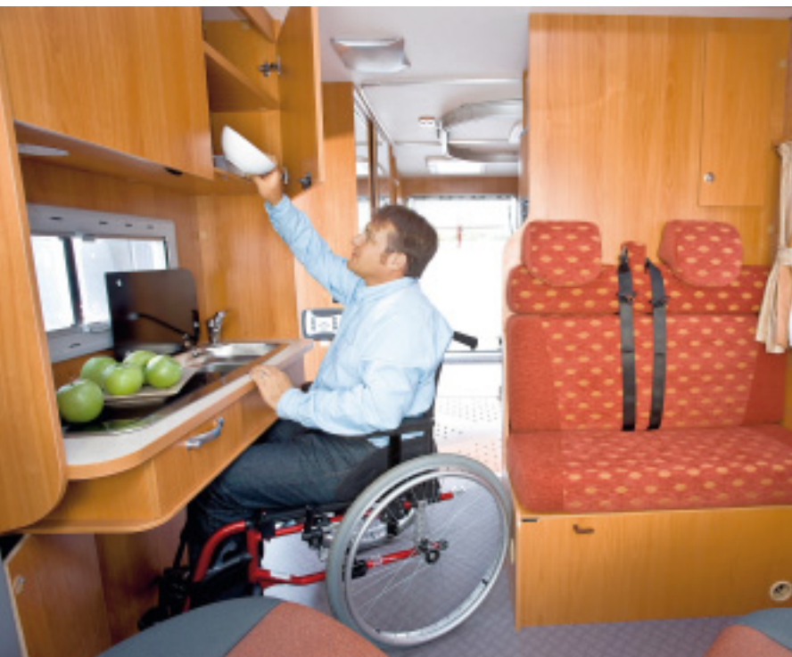
Gut gelöst: Die Küche im Mobil Star ist bequem unterfahrbar, die Oberschränke sind tiefer gesetzt, damit der Küchenchef trotz Handicap problemlos an der Kombüse arbeiten kann.
