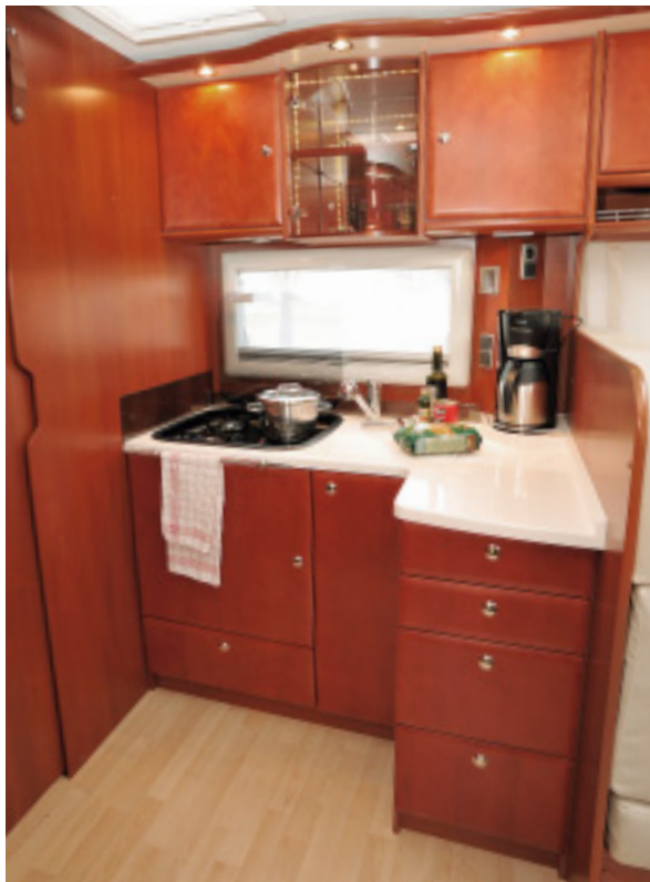
Der Spinflo-Kocher überzeugt mit großen Abständen zwischen den Brennern. Mit der am Rand hochgezogenen Arbeitsplatte sorgt Concorde dafür, dass kein Wasser hinter die Möbel läuft.
