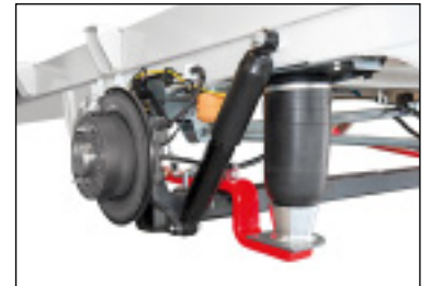
Vollluftfeder mit Rollbalg. Rollbälge erlauben große Hübe. Ideal fürs Nivellieren.
