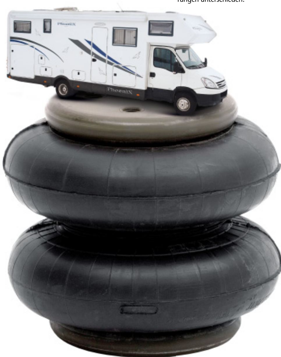
Zusatzfeder mit Faltenbalg. Diese brauchen wenig Platz, haben aber auch weniger Hub.
