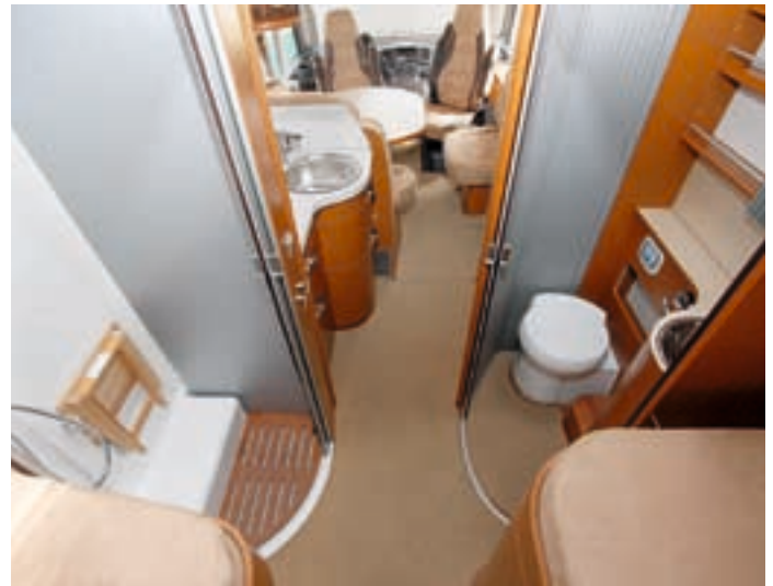
Raumbad: Für mehr Platz auf der Toilette wird der Waschbeckenschrank schmaler und der Türverlauf verändert. Die versenkte Duschwanne bleibt, wie sie ist.
