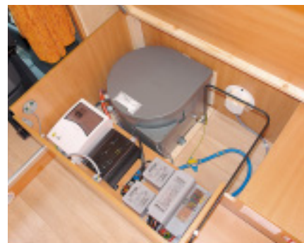
Benutzerfreundlich: Heizung und Elektrozentrale stehen in der Längsbank des Chausson Flash 26.
