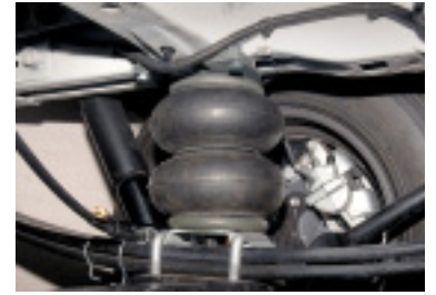
Zusatzfeder mit Faltenbalg. Diese brauchen wenig Platz, haben aber auch weniger Hub.
