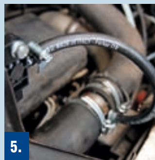
5. Das Rohrstück mit den Sensoren ist im Ladeluftschlauch implantiert, im Vordergrund der Schlauch zum Ladeluftdrucksensor. Seine Messdaten sendet er ans Steuergerät.
