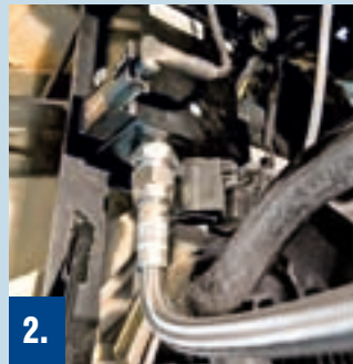
2. Die Einspritzeinheit wird am Unterboden links vor dem Tank montiert, vorhandene Bohrungen benutzt. Die Kraftstoffleitung im Vordergrund versorgt die Düse (siehe Schritt 3).
