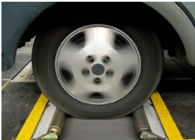
Zur Bestimmung der Abgaswerte von schweren Nutzfahrzeugen (HDV) läuft der Antriebsstrang auf einem Motorprüfstand. Leichtere Fahrzeuge (z. B. Fiat Ducato) gehen als Komplettfahrzeug auf den Rollensprüfstand.
