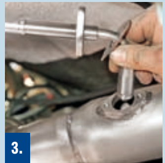
3. Die Einspritzdüse muss entgegen dem Abgasstrom in Richtung Motor am Eingang des Partikelfilters verschraubt werden. Links im Bild: die Verschraubung zum Motorkrümmen.
