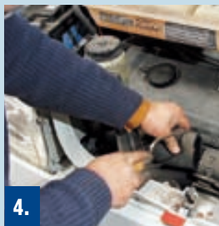
4. In den Ladeluftschlauch (vorn im Motorraum) implantiert: Rohrstück mit integriertem Ladeluftdruck- und Ladelufttemperatursensor. Der einzige Eingriff ins Fahrzeug.
