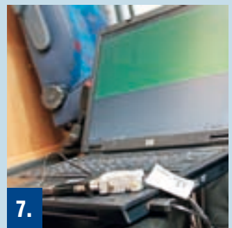
7. Im Lieferumfang enthalten: die Diagnosesoftware von Twintec. Der Kunde kann jederzeit via Diagnosestecker die Fehler auslesen und sie dem Service von Twintec mitteilen.
