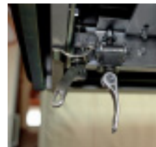
Hochwertige Schnellspanner arretieren den klappbaren Tisch. Auch an den Möbelklappen und Türen montiert Mobilvetta haltbare Beschläge.
