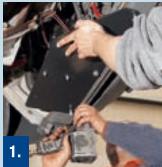
1. Vormontiert: Kraftstoffbehälter und Druckluftkompressor auf einer schwarz lackierten Trägerplatte. Montage: Von unten an den Fahrzeugrahmen hinter der vorderen Stoßstange.
