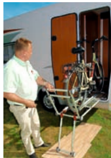
Ein Elektromotor zieht beim optionalen Bike-Up-System zwei Fahrräder samt Halter hochkant in den Heckstauraum.
