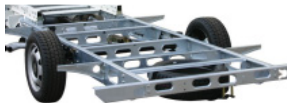
AMC-Chassis-Technologie von AL-KO – tiefer, breiter, leichter
