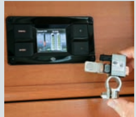
Der Batteriesensor erfüllt, ob die Akkus im Mobil noch in Ordnung sind.
