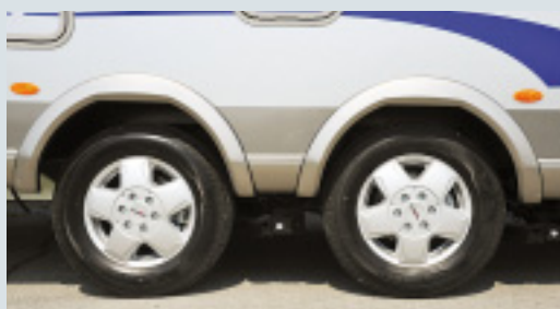
107 Zentimeter beträgt der Achsabstand beim Tandemachs-Sprinter. Angetrieben wird die vordere Achse (hier rechts).
