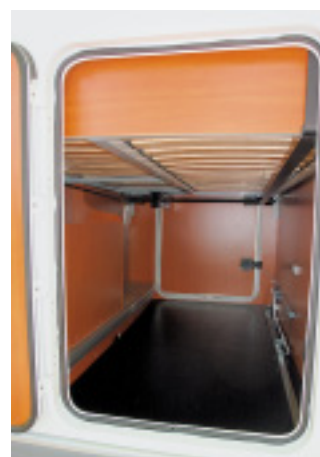
35 Zentimeter lässt sich das Querbett im Heck heben oder senken. So variiert auch die Höhe der Heckgarage.
