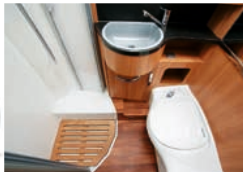
Bei der Nasszelle aus der B-Klasse muss zum Duschen der Lattenrost raus, die Kabine lässt sich sonst nicht schließen
