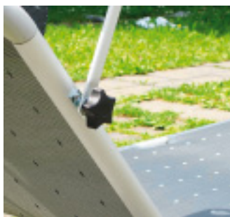
Solide: Das kleine Sonnendach der Bel Sol Tintoretto halten robuste Rändelmuttern. Fix demotiert.
