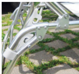
Robust: Vierstufige Kunststoff-Arretierung und Aluminium-Scharniere der Dukdalf Flamenco Mini.
