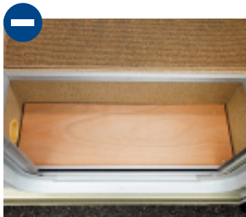
Unter dem Teppichboden der Trittstufe liegt nur ein unbehandeltes Holzbrett.
