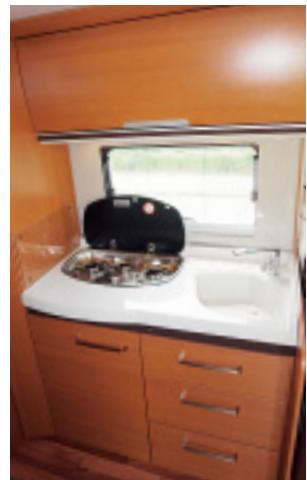
**Stark aufgewertet:** Niesmann + Bischoff optimiert den Arto unter anderem mit einer GfK-Küchenplatte aus einem Guss sowie einem leichten Tisch, der in alle Richtungen verschiebbar ist.
