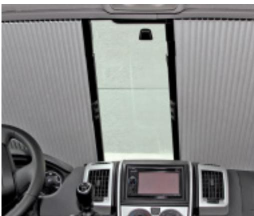
Geschlossen verstecken sich die beiden Hälften des Frontsystems an den A-Säulen. Vorn schließen sie bequem durch leichten Druck.
