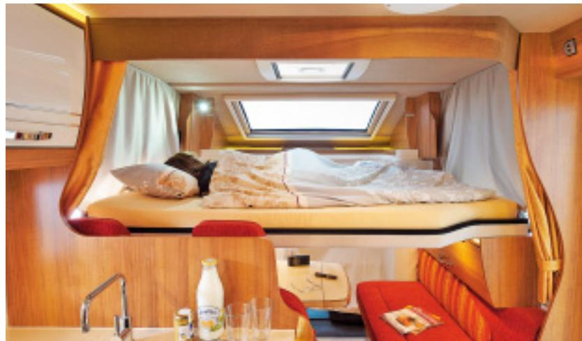
*Der Eura Mobil Terrestra T 710 HB unterscheidet sich äußerlich nicht von dem Modell ohne Hubbett. Das Bett wird elektrisch abgesenkt. Die Fernbedienung ist neben dem Control-Panel im Möbelkorpus integriert.*
