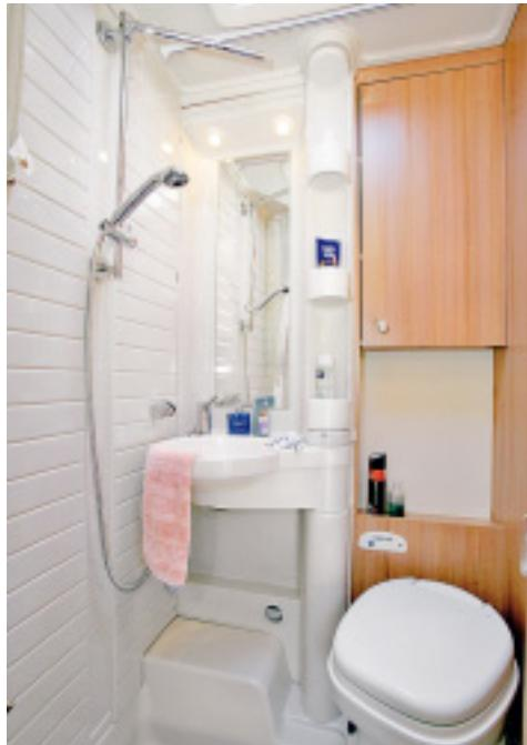
**Um die Dusche zu nutzen, muss das an einer Kunststoffführung aufgehängte Waschbecken zur Seite gedreht werden. Dann lässt sich der Vorhang an einer Schiene zum schützenden Halbkreis ziehen. Ablagemöglichkeiten gibt es im kleinen Bad zur Genüge, Hygienartikel nimmt auch der Wandschrank über dem WC auf.**
