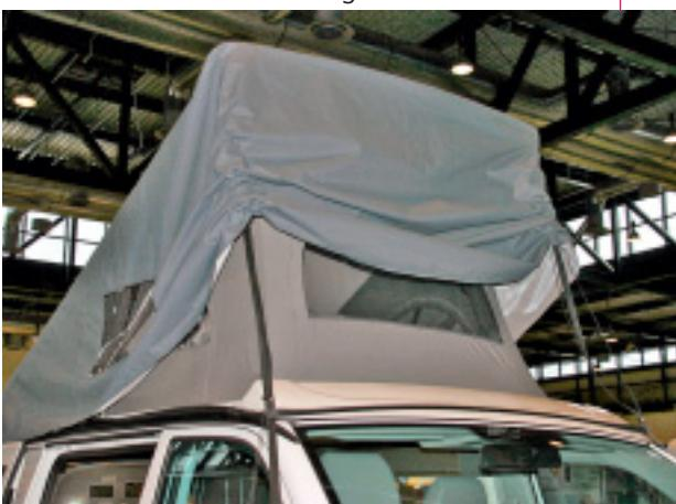
daches und dem Airtex-Überzug wirkt isolierend. Auf Wunsch arbeitet Camprotec Sichtfenster aus Klar-sichtfolie ein. Camprolift wird etwa 500 Euro kosten und wiegt nur 2,85 Kilogramm. Tel.: 07127/925824, [www.camprotec.de](http://www.camprotec.de)
