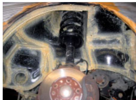
*Der Fachmann legt alle Roststellen frei und strahlt sie mit Trockeneis oder Korund. Im Radkasten bildet bereits der schwarze Schutzlack sicheren Rostschutz. Das Fett kommt an gefährdeten Bereichen, etwa an Falzen, zum Einsatz. Im Fahrbetrieb färbt Straßenstaub das helle Konservierungsmittel nach kurzer Zeit schwarz.*
