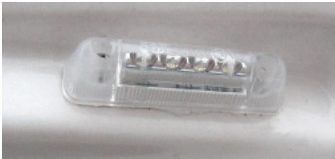
Die LED-Leuchte sitzt nach der Reparatur gut abgedichtet in einem Bett aus Sikaflex-Kleber an der Reisemobil-Karosserie.
