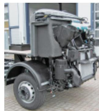
Die Bodenplatte reicht bis an das GfK-Element. Eine weitere Isolierung auch von vorn ist noch möglich.
