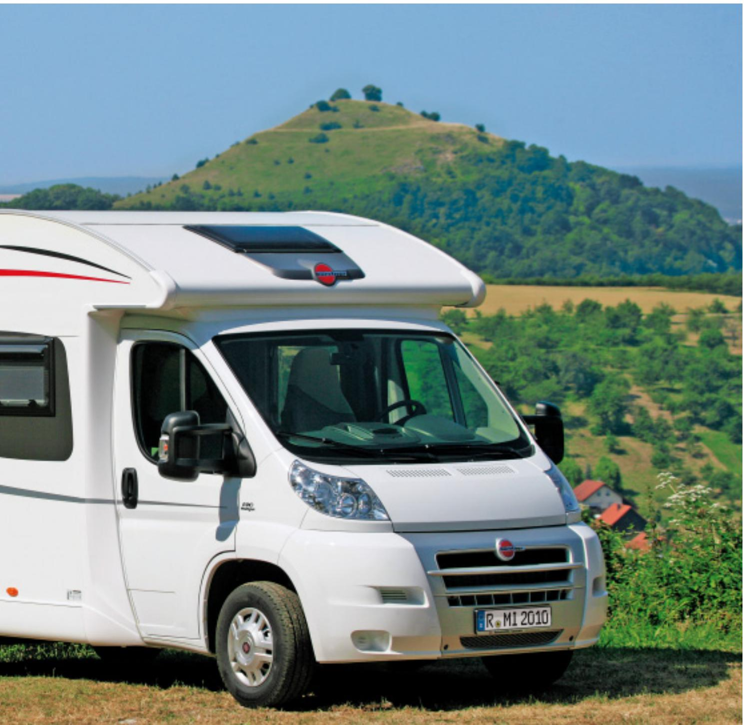
verpresstem Holz hält die Firma bei diesem Modell fest und handelt sich, solange sie wie bei diesem Modell imprägniert und geschützt ist, keinen Nachteil ein. Aus GfK laminiert und mit PU-Schaum isoliert ist die elegante Hutze über dem Fahrerhaus. Darin eingelassen: Ein aufstellbares Fenster, das viel Licht zur Sitzgruppe durchlässt, bei Bedarf aber ein in stabilen Schienen laufendes Faltenrollo schließt. Den Übergang zwischen Hutze und Fahrerhaus dichten
