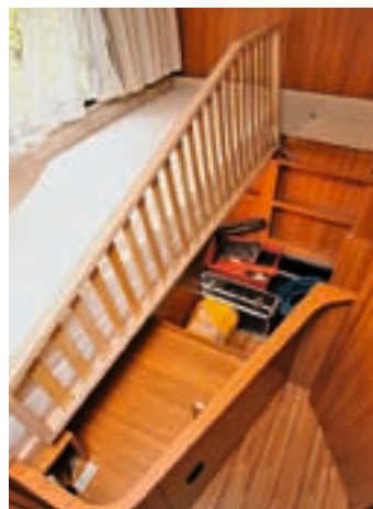
Freie Wahl: Klappt man den Lattenrost weg, kommt man auch vom Wageninneren an den Heckstauraum.
