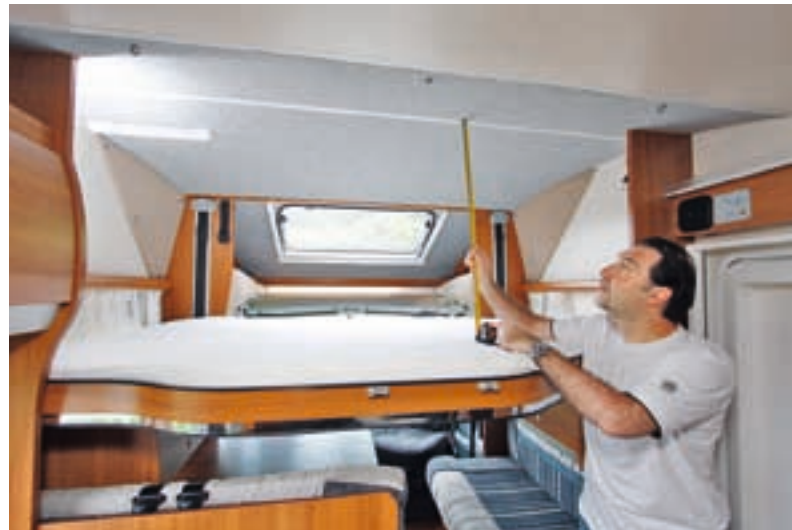
Freie Wahl: Da sich das elektrisch absenkbare Hubbett stufenlos einstellen lässt, kann man die verbleibende Kopffreiheit selbst wählen. Maximal sind es 74 Zentimeter.
