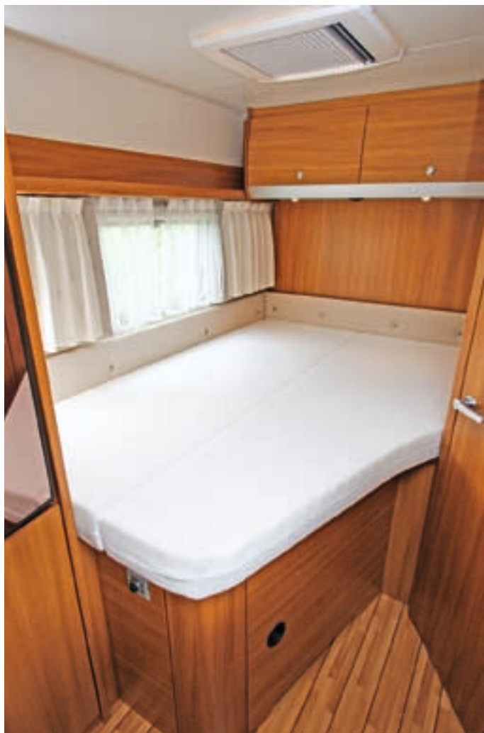
Kompromisslösung: Die Liegefläche des Heckbetts verjüngt sich zum Fußende hin deutlich, um den Zugang zum Badezimmer zu ermöglichen.
