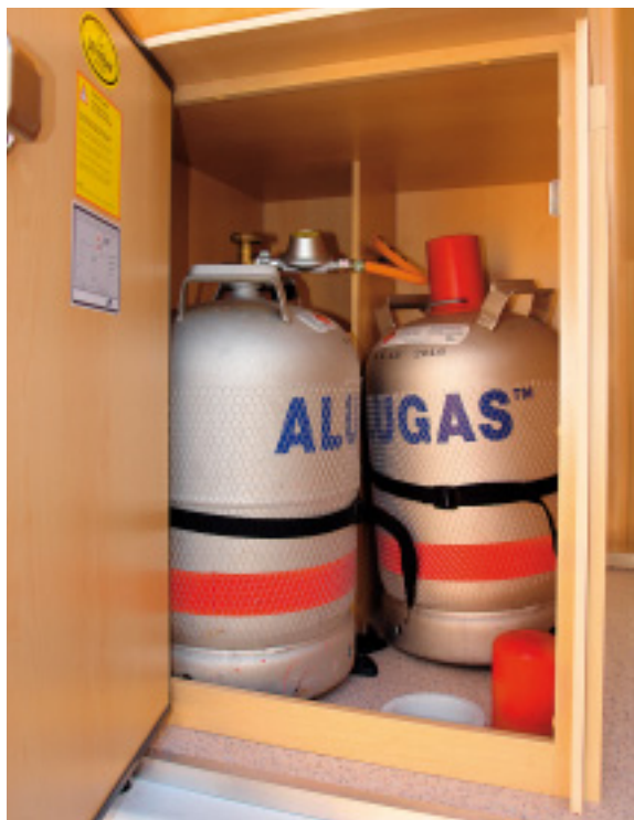
Gasflaschen – hier die leichten von Alugas – müssen fest verzurrt stehen. Die weiße Lüftungsöffnung ist frei zu halten.
