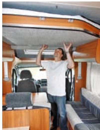
Freie Wahl: Da sich das elektrisch absenkbare Hubbett stufenlos einstellen lässt, kann man die verbleibende Kopffreiheit selbst wählen. Maximal sind es 74 Zentimeter.
