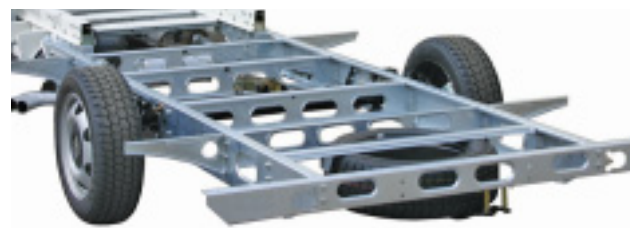
AMC-Chassis-Technologie von AL-KO – tiefer, breiter, leichter
