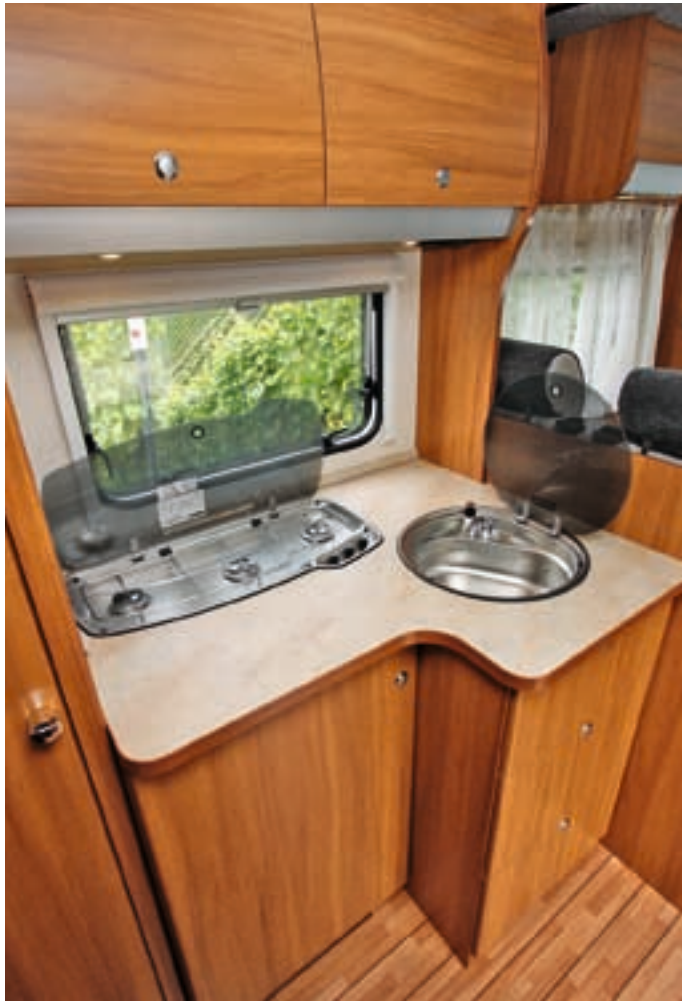
Intelligent gemacht: Zugunsten von deutlich mehr Arbeits- und Ablagefläche setzt Knaus einen Herd mit drei in Reihe stehenden Flammen in die Küche.
