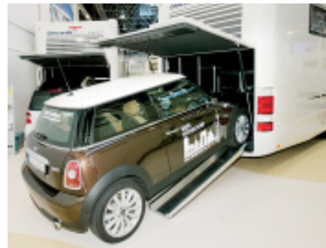
Heckgaragen gibt es bei Concorde in den unterschiedlichsten Größen. In die Garage des 1140 Gmini zieht die elektrische Seilwinde sogar einen Mini. Die üppige Breite des Liners macht dies möglich.
