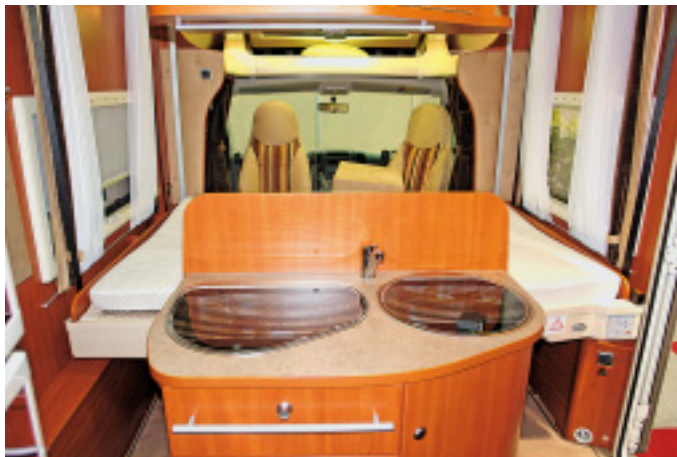
Im Challenger Prium lässt sich das Hubbett auf zwei Höhen arretieren. Die untere Bett-Position ist bequem vom Boden aus zu nutzen, ohne über eine Leiter klettern zu müssen. Der Küchenblock ist mittig untergebracht.
