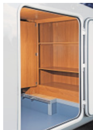
An der Rückwand der Heckgarage montiert LMC ein Regalsystem – ideal für allerlei Krimskrams. Die Truma-Heizung samt Ablassventil ist auf der rechten, ein weiteres, geschlossenes Regal auf der linken Seite eingebaut.
