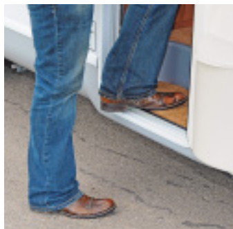
Dank innenliegendem Tritt kommt der LMC Explorer ohne elektrisch ausfahrbare Stufe aus.
