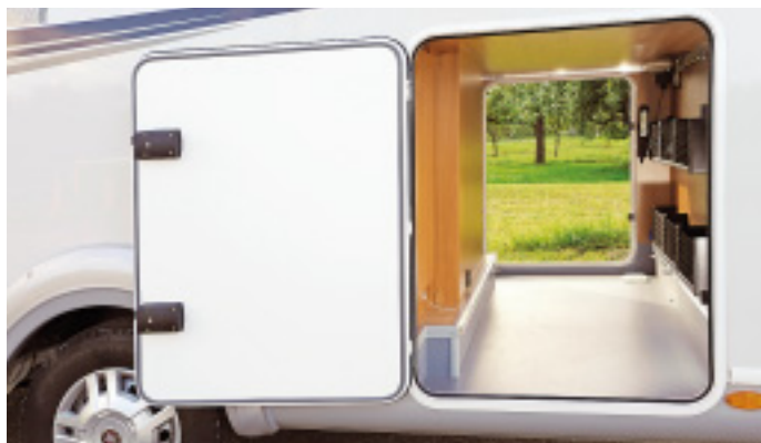
An der Rückwand der Heckgarage montiert LMC ein Regalsystem – ideal für allerlei Krimskrams. Die Truma-Heizung samt Ablassventil ist auf der rechten, ein weiteres, geschlossenes Regal auf der linken Seite eingebaut.
