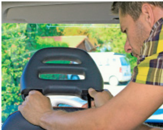
Aller Anfang ist leicht. Der Einbau beginnt mit dem Abnehmen der Nackenstützen.
