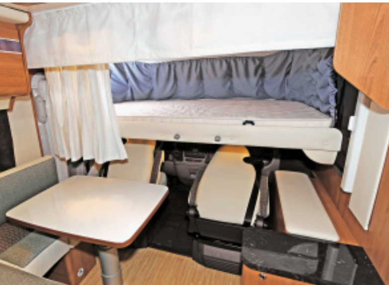
Ob hochgefahren oder abgesenkt, das Hubbett ist in jeder Position sicher arretiert. Während der Fahrt bleibt es ruhig, nichts klappert.
