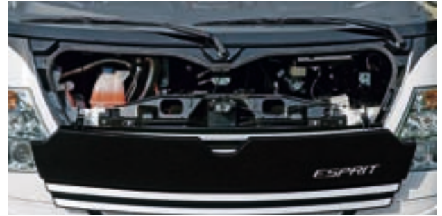
Die Klappe fällt und gibt eine angenehm große Öffnung für die wichtigsten Servicearbeiten frei: Öl kontrollieren und nachfüllen zum Beispiel.
