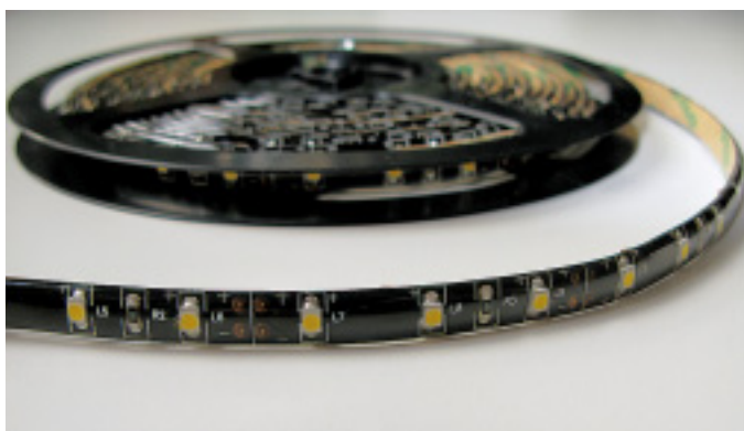
Fast überall im Reisemobil setzen so genannte LED-Flex-Strips Akzente. An der Stelle zwischen den LEDs L6 und L7 lässt sich das Band kappen.
