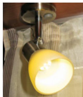
Mit weniger LEDs ausgerüstet, benötigt das zweite Modul nur 0,7 Watt.
