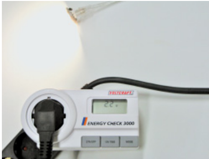
Das Messgerät zeigt: Die über einen Umformer angeschlossene LED-Platine mit 140 Lumen (20 Watt) Leuchtstärke benötigt nur etwa 2,2 Watt.
