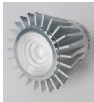
Eine einzige Power-LED leuchtet hier mit 70 Lumen (15 Watt). Durch ihren hohen Lichtstrom benötigt dieses Leuchtmittel einen Kühlkörper.
