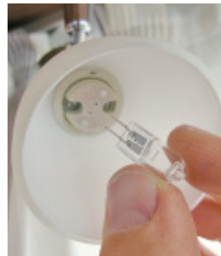
Ist die Halogenbirne abgekühlt, lässt sie sich aus dem G4-Sockel ziehen.
