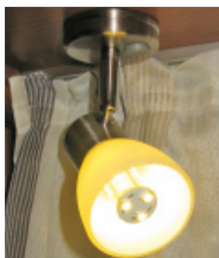
Im Betrieb nimmt das erste LED-Modul nur rund 2,5 Watt auf.
