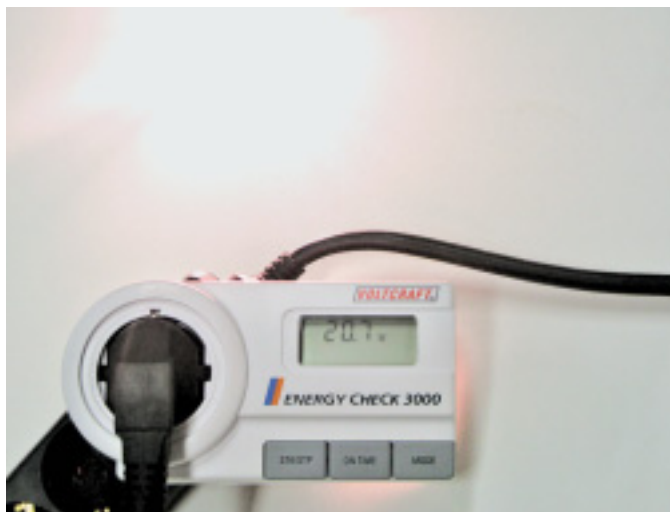
Die mit demselben 230-Volt/12-Volt-Umformer betriebene 20-Watt-Halogenleuchte bezieht 20,7 Watt aus dem 230-Volt-Netz.
