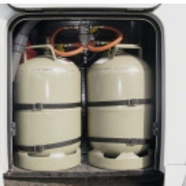
Vorbildlich gestaltet Hymer den Gaskasten. Die Flaschen lassen sich leicht tauschen und sicher befestigen.
