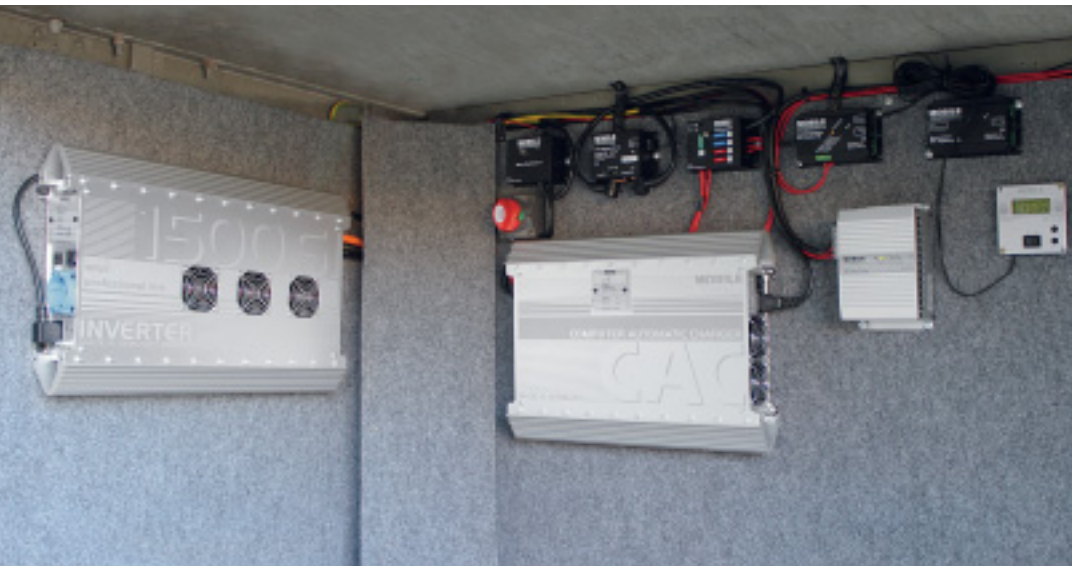
Bordelektronik im Überblick. Batterieladegerät und Inverter sind hier als zwei Einzelgeräte verbaut, der Batteriecomputer (rechts) überwacht Ladung und Entladung.
