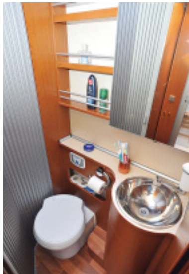
Die Duschwanne im Doppelboden schließt bündig mit dem Fußboden ab. In der Toilette spart die verspiegelte Schiebetür des Kosmetikschrank wertvollen Platz. Dusche und WC lassen sich zum Raumbad erweitern.
