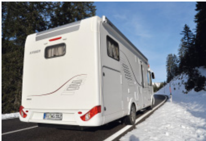
Den formschönen Aufbau fertigt Hymer ohne Holzfachwerk in der so genannten PUAL-Bauweise. Große Stauklappen gewähren den Zugang zur Heckgarage.
