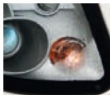
**Zugefrorene Öffnungen am Dach verhindern, dass tauender Schnee abläuft. Die Dichtungsgummis an den Scheinwerfern lassen offenbar Wasser durch.**
