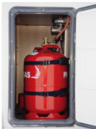
**Beim Gasflaschentausch bleibt man leicht an den in den Türausschnitt ragenden Haltewangen hängen.**
