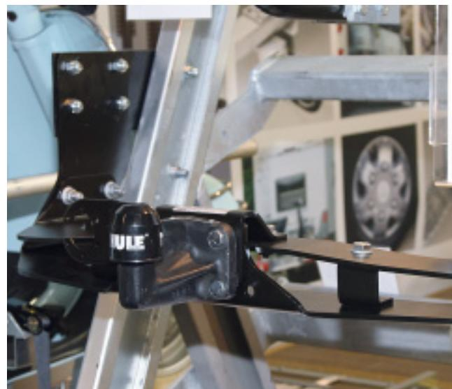
tenform, sondern aus mit Knotenblechen verbundenen Flacheisen. Damit reduziert Linnepe das Gewicht nach eigenen Angaben um 50 Prozent. Die neue Anhängerkupplung ist KTL-beschichtet, soll ab Mitte 2011 lieferbar sein und knapp 500 Euro kosten. Die Konstruktion ist bis zu einer Anhängelast von 3,5 Tonnen ausgelegt. Info-Tel.: 02333/98590, [www.a-linnepe.de](http://www.a-linnepe.de)
