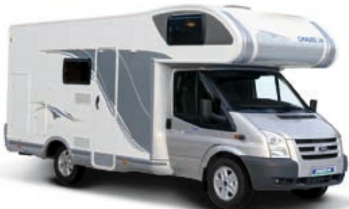
obendrein noch einen Tempomat. Dach und Wände der Aufbauten bestehen aus Hagelresistenterem Gfk.
