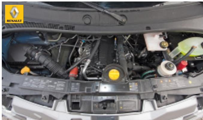
Das längs eingebaute 125-PS-Triebwerk lässt im Master viel Platz. Sehr gut hat Renault den Öleinfüllstutzen an der vorderen Quertraverse platziert.
