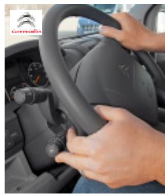
Je nach Lenkradstellung ist beim Citroën Jumper der Hebel für den Tempomat leicht mit dem für den Blinker zu verwechseln. Der Bordcomputer lässt sich ohne Bedienungsanleitung kaum beherrschen.
