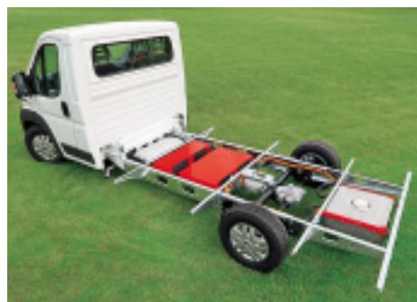
**Wegweisend? Al-Ko Electric Power Chassis mit E-Motor an der Hinterachse. Aber: ziemlich schwer.**
