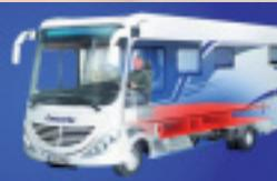
Concorde Reisemobile sind der Maßstab. Nehmen Sie beispielsweise das Concorde Doppelbodenkonzept: Damit Sie mehr Platz zum Wohnen haben, befindet sich die gesamte Reisemobiltechnik raumsparend und für Sie unsichtbar im Doppelboden. Zahlreiche Aggregate wie die Klimaanlage oder die Heizspiralen der Warmwasser-Heizung sind hier installiert und
