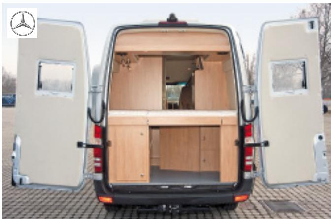
Am Mercedes-Benz Sprinter öffnen die Türen in gleicher Weise und geben eine 184 mal 155 Zentimeter große Öffnung frei.
