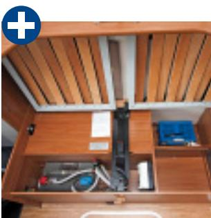
Die Elektrozentrale steht griffbereit unter der Längsbank.
