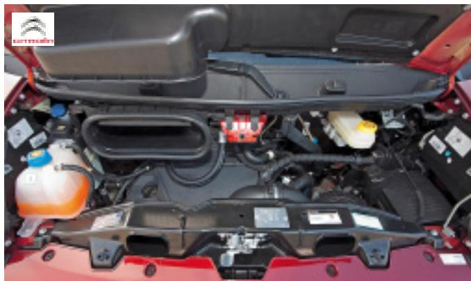
Enger ist es unter der Haube des Jumper. Der quer eingebaute 120-PS-Turbodiesel liegt tief im Motorraum. Öl einzufüllen, erfordert etwas mehr Geschick.
