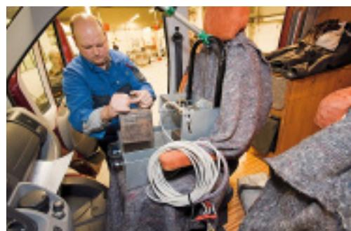
Die Messapparatur mit 3-D-Sensoren und Mikrofon samt 75 Kilogramm Beifahrersimulationsgewicht.
