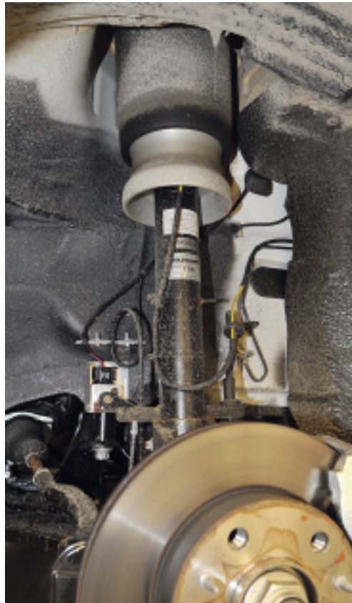
Alles neu. Die luftgefederten Federbeine vorne bestehen aus einem speziell darauf abgestimmten Stoßdämpfer, einem Druckbalg und einem geänderten Domlager. Feinfühligere Sensoren ermitteln die Lage des Mobils.
