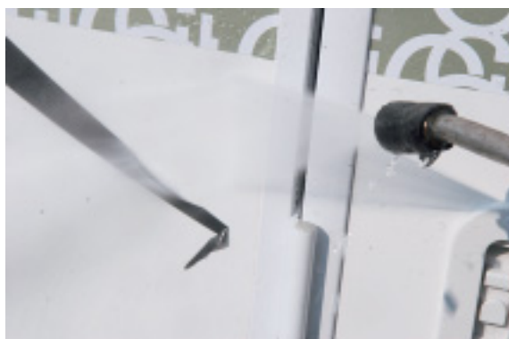
Mit dem Strahl nicht direkt unter die Fensterkante halten. Dichtungen können sonst beschädigt werden und Wasser dann ins Fahrzeuginnere eindringen.
