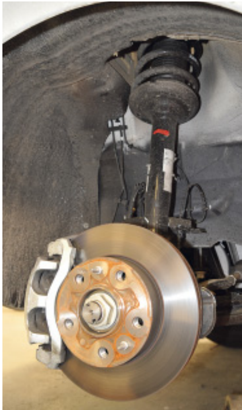
Mc-Pherson-Federbein mit Schraubenfeder an der Vorderachse des Fiat Ducato. Bei den stahlfederierten Integrierten hat Hymer die Serienfeder durch verstärkte Goldschmitt-Schraubenfedern ersetzt.
