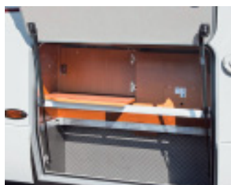
Eine Starline-Spezialität: Hohes Fach hinter der Fahrertür, das per Brett unterteilt und zum Fußraum für Passa-giere umgestrickt werden kann (links).
