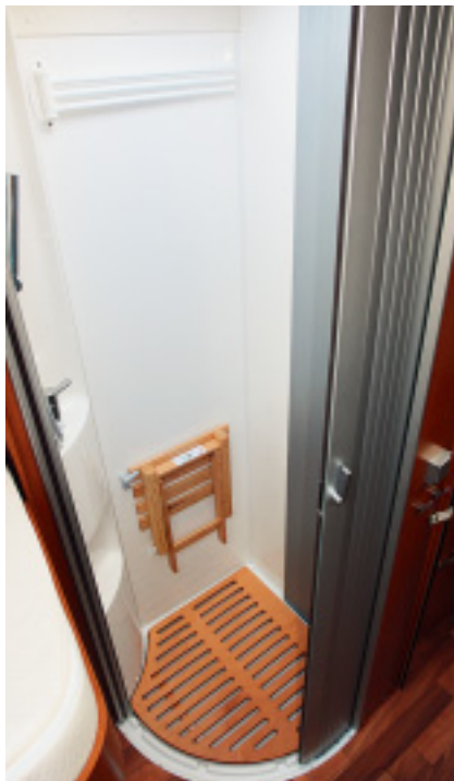
Das hat nur der Starline auf Sprinter: Duschwan-ne ohne Radkasten-Beule. Möglich macht das der 12,5 Zentimeter hohe Doppelboden.
