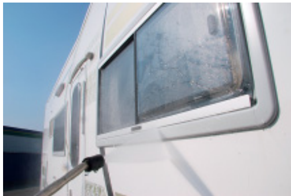
Mit dem Strahl nicht direkt unter die Fensterkante halten. Dichtungen können sonst beschädigt werden und Wasser dann ins Fahrzeuginnere eindringen.
