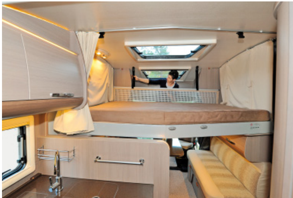
Elektrisch absenkbar: Das Hubbett wird stufenlos abgelassen. Dadurch wählt man die verbleibende Kopffreiheit selbst. Am Fußende verjüngt sich die Liegestatt von 130 auf knappe 110 Zentimeter.
