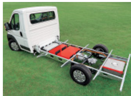
Wegweisend? AI-Ko Electric Power Chassis mit E-Motor an der Hinterachse. Aber: ziemlich schwer.
