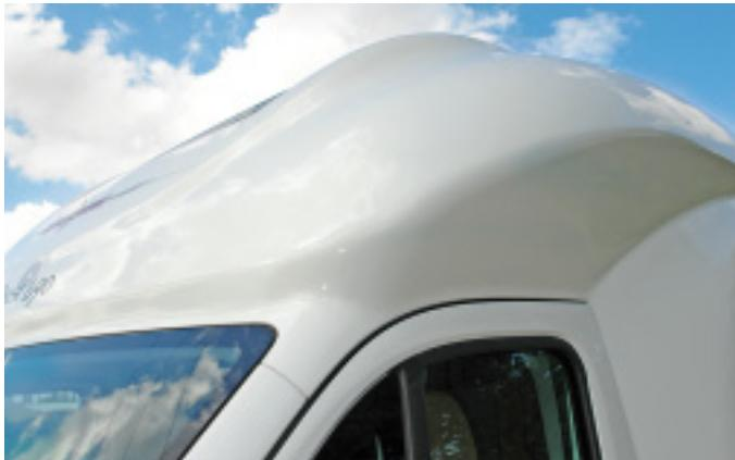
**Aus einem Guss:** Die Monocoque-Kabine kommt ganz ohne Nähte aus, durch die Feuchtigkeit ins Fahrzeuginnere dringen könnte. Sie ist perfekt angepasst.
