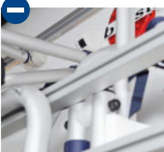
**Falsch platziert: Die Rückfahrkamera zeigt nur Stangen des Fahrradträgers.**
