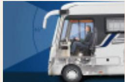
Sicherheit geht vor. Damit Sie entspannt und sicher an Ihrem Reiseziel ankommen, hat Concorde ein innovatives Konzept zur Höhersetzung des Fahrerhauses entwickelt. Der Fahrer- und Beifahrersitz wurden 260 mm nach oben, 300 mm nach vorn und 120 mm nach außen versetzt. Dadurch erhält jedes
