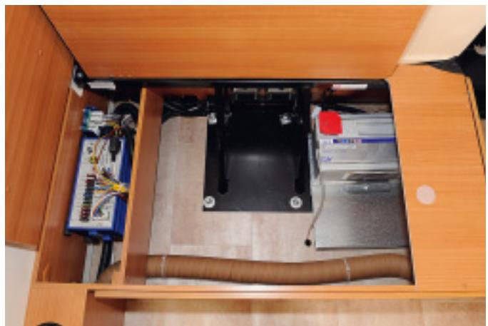
Bürstner montiert die Elektrozentrale in der Sitzbank. Das Montageblech unter der Batterie ist bereits für einen zweiten Akku vorbereitet.
