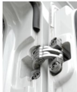
**Solide Sache:** Die dicke Aufbautür ist geschäumt und mit extrem robusten Metallscharnieren ausgestattet.
