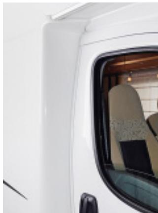
Mit Sikaflex wird penibel umgegangen, wie die Dichtnähte beweisen.
