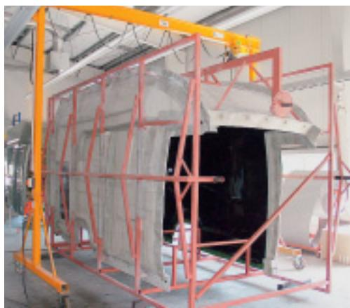
*Handarbeit: Am Werkstück spachteln und schleifen Fachleute, bis alle Oberflächen glatt sind (oben). Ein Stahlgerüst stabilisiert das Werkzeug vor dem Laminieren.*
