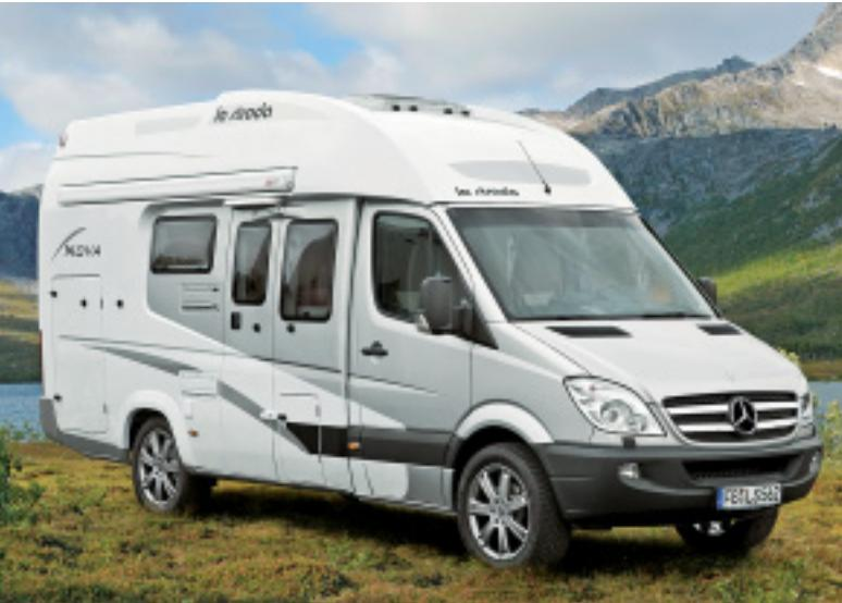
**Auch hier trägt der Schein:** Der Nova ist kein Kastenwagen, sondern trägt eine GfK-Kabine.
