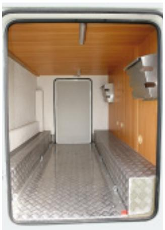
**Hinterlader:** Die voluminöse Heckgarage hat Aluschienen, Zurrösen und eine zweite Klappe.
