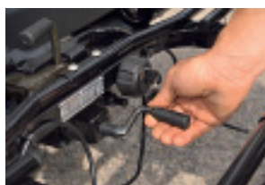
Die Kurbel sichert den MFT und ermöglicht das Abkippen zum Beladen des Kofferraums.
