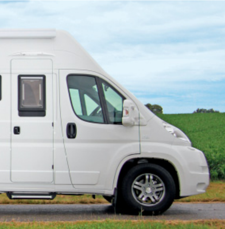
In Stehhöhe ins Fahrerhaus. Die B-Säulenverbindung wurde herausgenommen.
