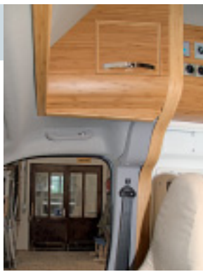
In Stehhöhe ins Fahrerhaus. Die B-Säulenverbindung wurde herausgenommen.
