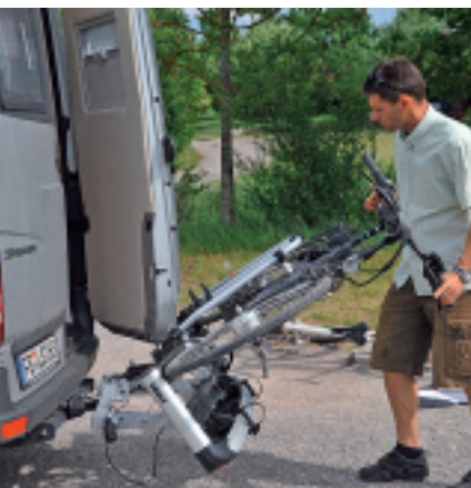
Der Abklappmechanismus ermöglicht am Pkw das Öffnen des Kofferraumdeckels.
