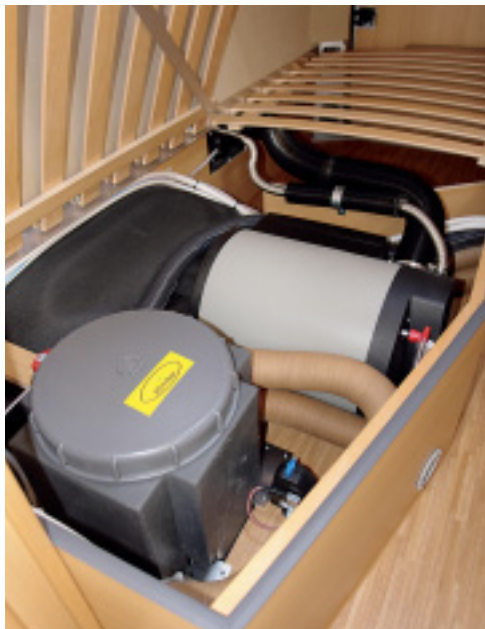
Unter das untere Bett stellt CS die Truma-Combi-6-Heizung nebst Boiler, Ablasshahn und Druckwasserpumpe.
