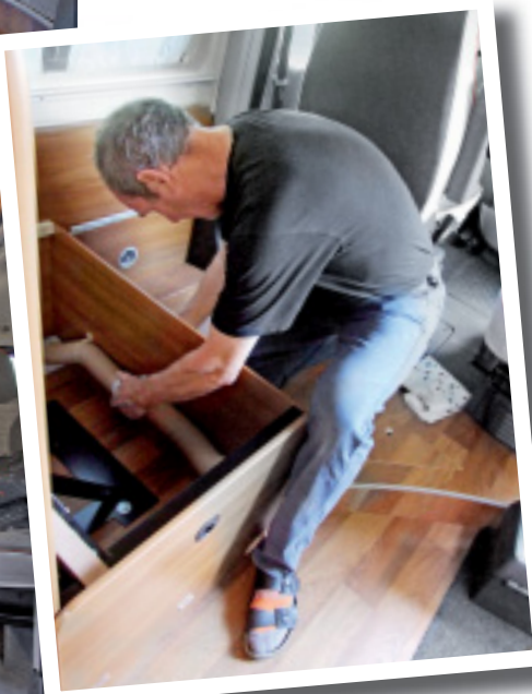
Die Sitztruhe um den Gurtbock wird abgeschlagen. Der Bock selbst bleibt, um die Vier-Personen-Zulassung zu erhalten.
