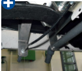
Abwasserrohr und Ferntriegelung fixiert Rapido an massiven Haltern.
