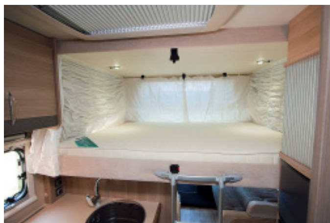
Das 184 mal 128 Zentimeter große Hubbett bedienen müde Camper spielend ohne Motorkraft und genießen dann eine Kopffreiheit von 70 Zentimetern.
