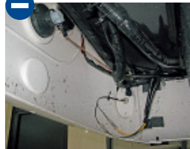
Die Kabel der Rück- und Positionsleuchten sind teils lieblos verlegt.
