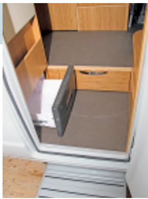
Kühlbox mit Zugriff von außen. In der Mitte eine Schuhschublade samt Fach für Schuhputzzeug.
