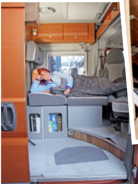
Die Sitztruhe um den Gurtbock wird abgeschlagen. Der Bock selbst bleibt, um die Vier-Personen-Zulassung zu erhalten.
