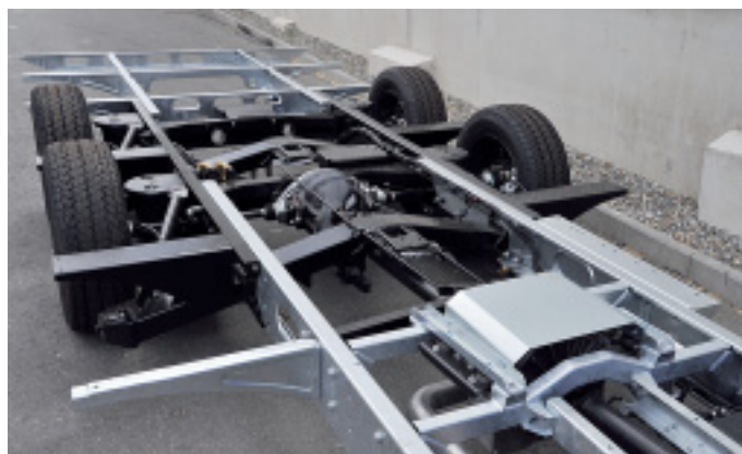
Der Sechszylinder treibt die erste der beiden hinteren Achsen an. Die zusätzliche Achse wiegt 300, der Retarder nochmals 100 Kilogramm.
