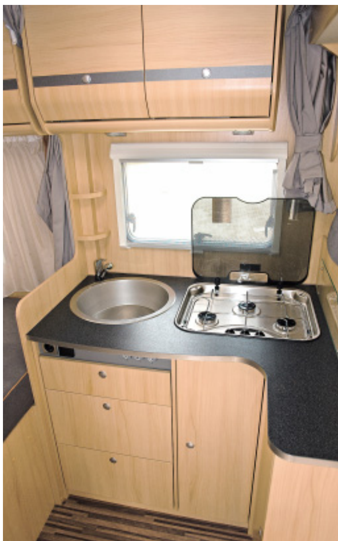
Mitgedacht: Die Gasabsperrhähne sind leicht bedienbar an der Küchenfront montiert.
