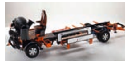
Fahrzeugbau Meier GmbH... ... für das Iveco-Daily-Liner-Chassis, das besser isoliert und fast 100 kg leichter wurde.
