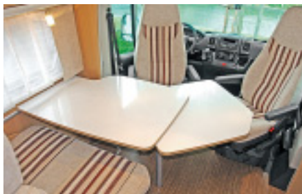
Bei der Halbdinette gefällt der stabile, mit 75 Zentimeter Breite sehr gut nutzbare Tisch. Seine Fläche lässt sich mittels Ausschwenkplatte so erweitern, dass er perfekt an jeden Sitzplatz reicht.
