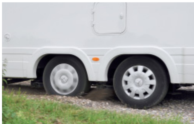
Klar zu sehen: Nur eine Hinterachse ist angetrieben. Auf losem Untergrund tut sich der Dreiaxser ohne aktivierte Anfahrhilfe schwer.
