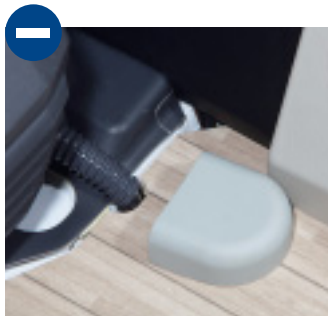
Die Abdeckung der Warmluftzufuhr löst sich beim kleinsten Schubs.
