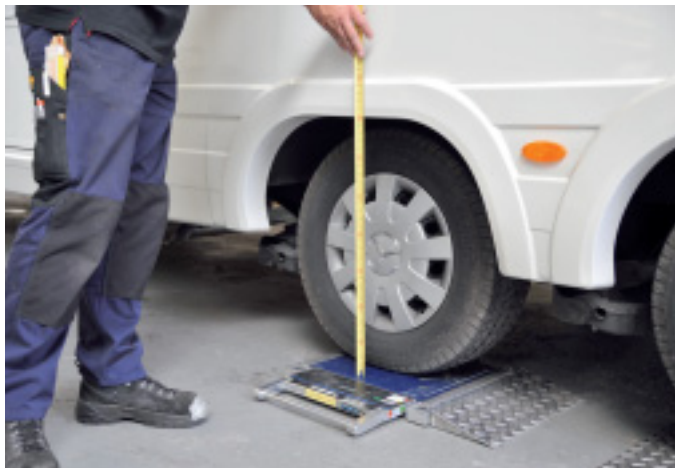
Das Heck kann dank der Luftfederung auf Knopfdruck abgesenkt und hochgefahren werden. Die Amplitude beträgt an der zweiten Achse 10,5 Zentimeter.
