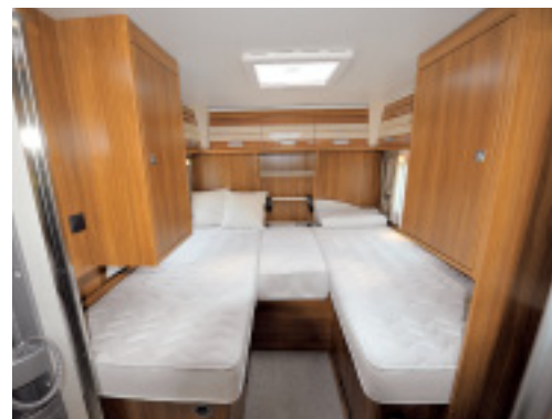
Eigenerkabinen: Im Esprit thronen zwei längs montierte Etagenbetten im Heck, aus denen sich ein großes Doppelbett bauen lässt.
