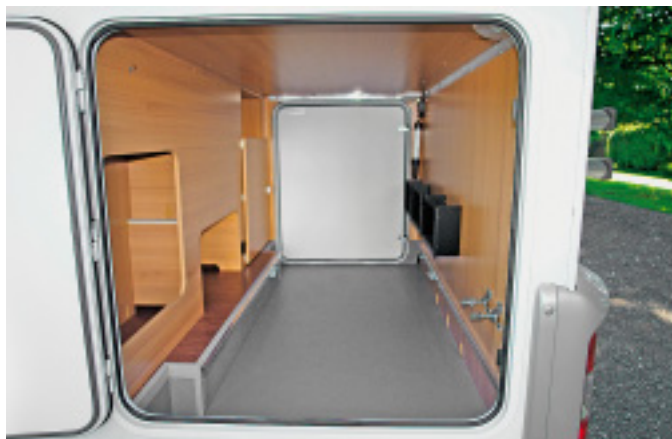
Die Heckgarage mit zwei Innenleuchten glänzt dank Heckgaragenpaket mit zweiter Tür, Stauraumsystem, Verzurrösen und einer zusätzlichen Akku-Stablampe.
