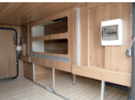
Die Heckgarage mit zwei Busklappen mündet in den Doppelboden.
