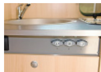
Mitgedacht: Die Gasabsperrhähne sind leicht bedienbar an der Küchenfront montiert.
