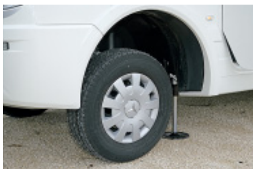
Die hydraulischen E&P-Hubstützen stellen das schwere Mobil zuverlässig in die Waagrechte.
