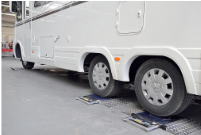
Mit sechs Plattenwaagen messen wir die genaue Gewichtsverteilung. Sie geben Aufschluss darüber, wie sich die Achslasten im Anfahrmodus ändern.
