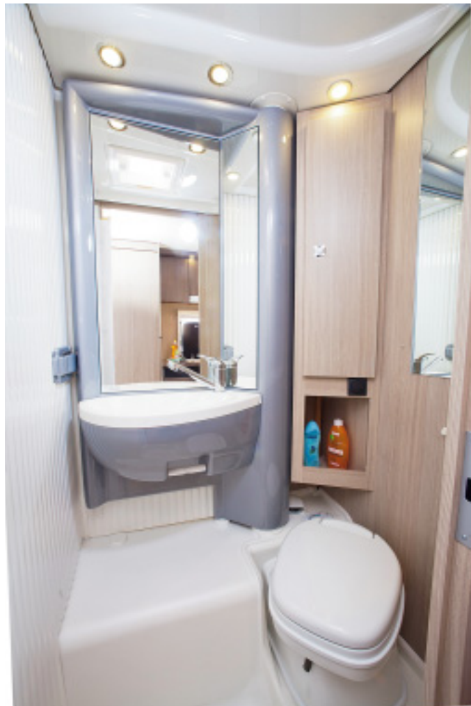
Die Rückwand mitsamt dem Waschbecken schwenkt über die Toilette. Damit werden der Eckschrank und die Toilette vor Spritzern aus der Dusche geschützt.
