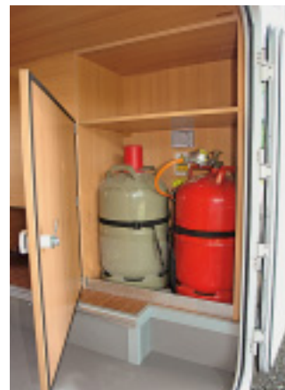
Der abschließbare Gasflaschenkasten kommt in der Heckgarage unter.
