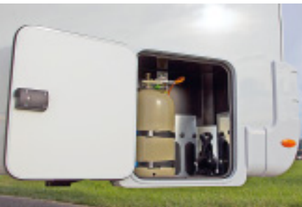
Der Gasflaschenkasten sitzt im Heck. Die Flaschen lassen sich gut erreichen und auch einzeln wechseln.
