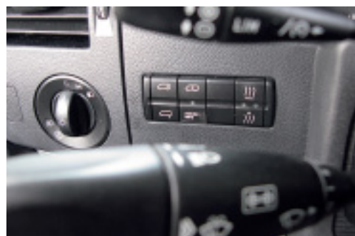
Die Schalter zum Aktivieren der Anfahrhilfe sowie zum Senken und Heben des Hecks liegen griffgünstig.
