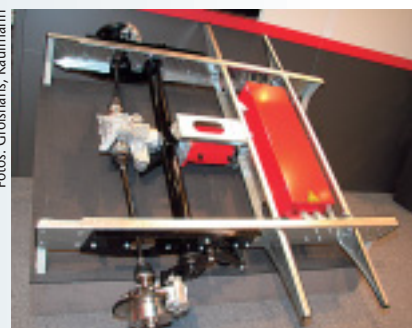
AL-Ko EPC, das „Electric Power Chassis“ mit Differenzial, E-Motor und Batteriekasten.
