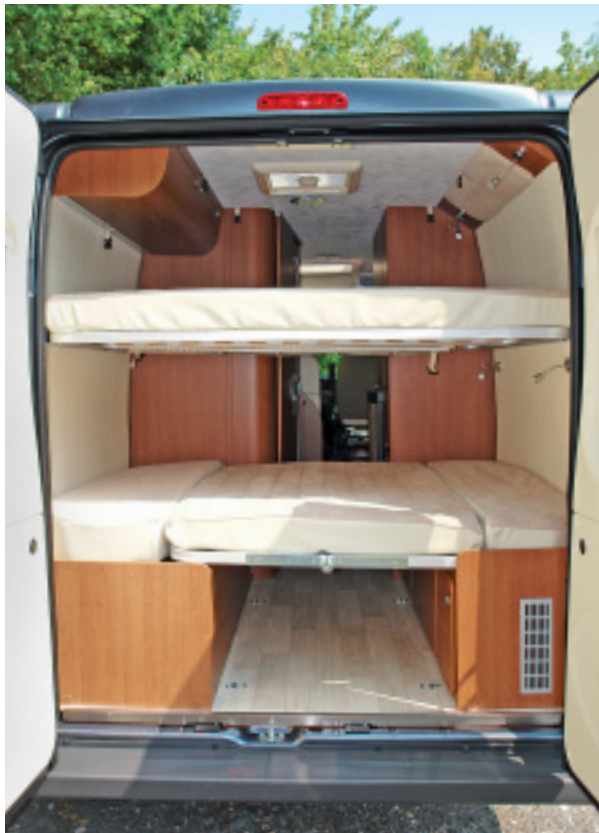
Doppeldecker: Ist man zu dritt oder zu viert unterwegs, verbleiben die beiden 140 Zentimeter breiten Betten im Twist. Die oberen Liegen lassen sich bei Bedarf aus dem Wageninneren ausbauen.
