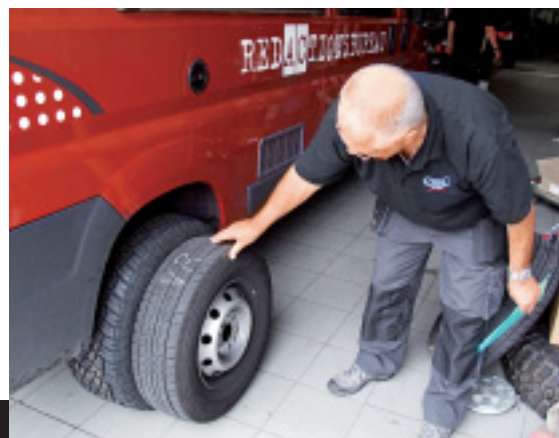
Kein Vergleich: Hier wird der Unterschied zwischen serienmäßigen 15- und den jetzt montierten 18-Zoll-Reifen sehr deutlich.
