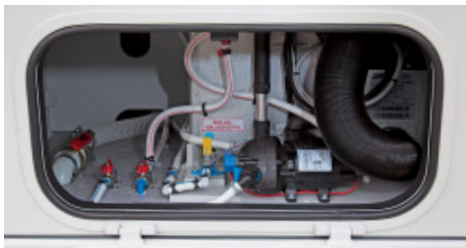
Die Frischwasserzentrale mit Druckpumpe, Entleerungsventilen und unmittelbar anschließendem Boiler. Trotzdem bleibt im vorderen Bereich eine praktische Durchlade.
