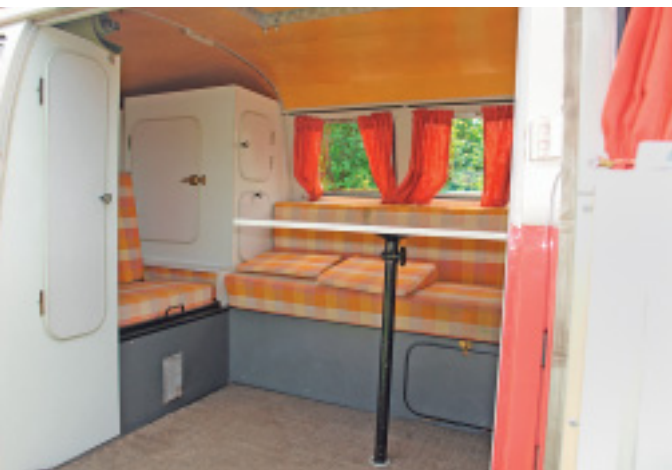
Aus Blech, aber kein Spielzeug: Cockpit des T1 mit Sitzbank, die mit umgedrehter Lehne in den Wohnraum integriert wird. Genial.
