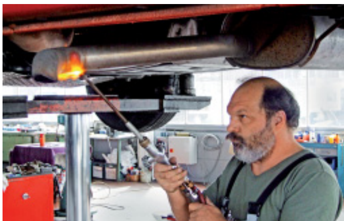
Das solide, selbst gebaute Motorschutzblech und der – zugegeben – eher rustikal höhergelegte Auspuff sollen die Folgen lindern, falls trotz Umrüstung auf 18-Zoll-Pneus der Boden zu nahe kommt.
