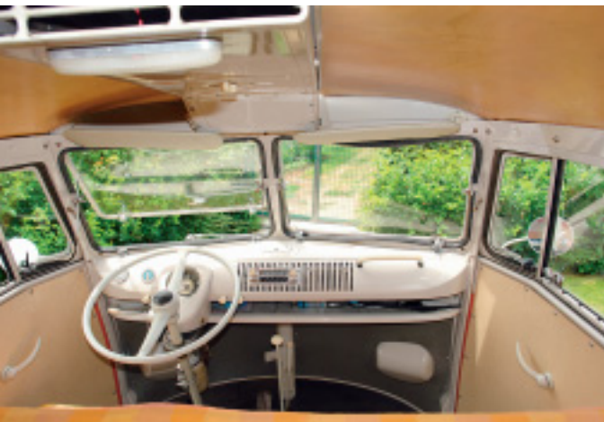
Aus Blech, aber kein Spielzeug: Cockpit des T1 mit Sitzbank, die mit umgedrehter Lehne in den Wohnraum integriert wird. Genial.
