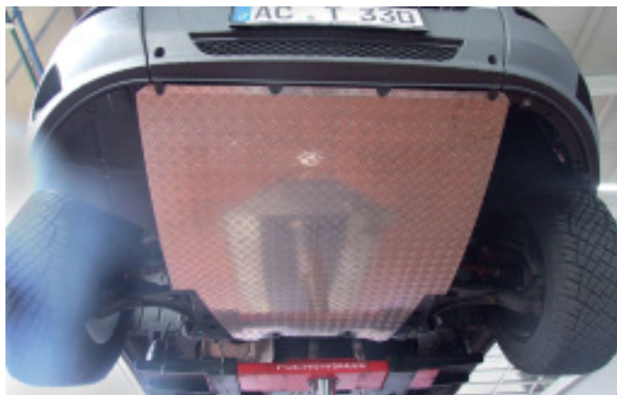
Das solide, selbst gebaute Motorschutzblech und der – zugegeben – eher rustikal höhergelegte Auspuff sollen die Folgen lindern, falls trotz Umrüstung auf 18-Zoll-Pneus der Boden zu nahe kommt.
