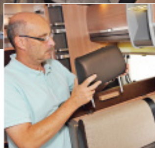
Das zwischen 13 und 20 Zentimeter breite Ablage-Board hinter der Sitzbank lässt sich abklappen. Darunter verbergen sich die stabilen Aufnahmen der Kopfstützen.
