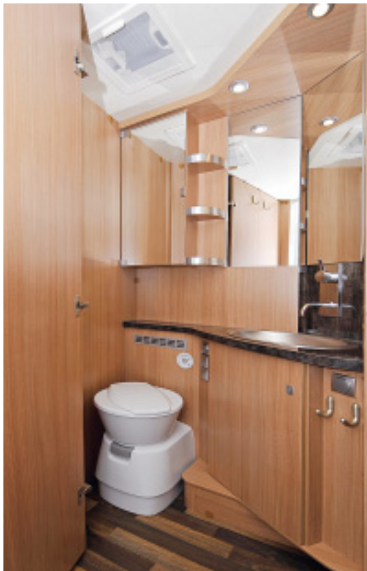
Die Dusche mit den runden Kunststoff-Türen sitzt auf der linken Seite des Mobils, das WC auf der rechten. Um das WC zu vergrößern, kann die Wand um 24 Zentimeter ausgezogen werden. Die Tür zum WC schließt dann immer noch sehr gut.
