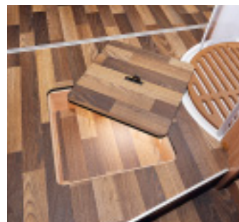
Ein Holzrost schützt die Duschwanne, insgesamt drei flache Stauräume sind in den Boden eingelassen.
