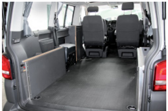
In rund einer Minute sind Sitzbank, Wassertank und Liegefläche ausgebaut. Es bleibt ein schienentreier, weicher Gummiboden mit Zurrösen.
