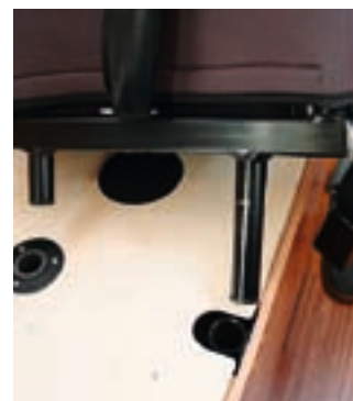
Der siebte Sitz, eine leichte Klappkonstruktion ohne Bodenverankerung, steckt in zwei Hülsen am Sitzkasten. Zulässig, aber nicht vertrauenswürdig. Wir raten deshalb davon ab.
