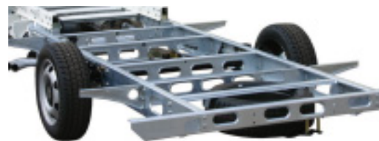
AMC-Chassis-Technologie von AL-KO – tiefer, breiter, leichter
