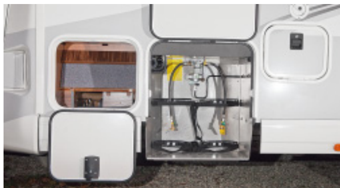
Ein Lochblech schützt die Elektrozentrale in der Heckgarage. Der Gasflaschenkasten sitzt angenehm tief und ist leicht zu bestücken.
