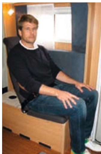
Der siebte Sitz, eine leichte Klappkonstruktion ohne Bodenverankerung, steckt in zwei Hülsen am Sitzkasten. Zulässig, aber nicht vertrauenswürdig. Wir raten deshalb davon ab.
