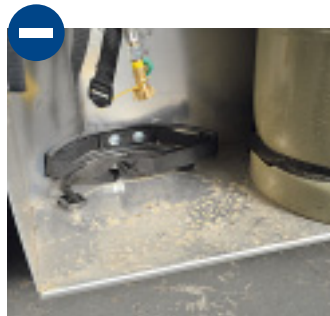
Über die Belüftungsöffnung dringt Schmutzwasser in den Flaschenkasten.
