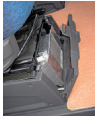
Ein Mini-Booster wird vor der Konsole des Beifahrersitzes montiert. Die Fußmatte wird ebenfalls von warmem Wasser beheizt.
