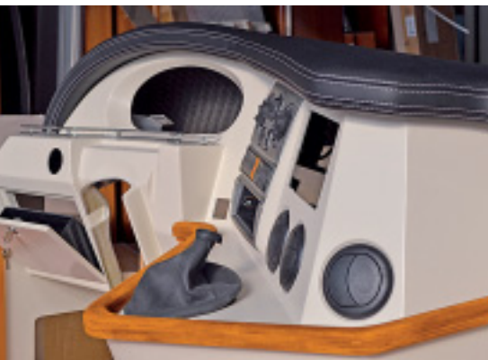
Concorde setzt seit Jahren bei seinen großen Fahrzeugen auf ein selbst gestaltetes Armaturenbrett. Jetzt wird es mit Getränkehalterungen und zusätzlichen Ablageflächen optimiert. Auch ein abschließbares Fach für Schlüssel oder Handy ist nun integriert. Außerdem verfügt das neue Armaturenbrett über eine hochwertige Kunstlederabdeckung und eine Holzreling. Zusätzlichen Nutzen verspricht die in das Armaturenbrett integrierte Zeitungsstange aus Leder. Das neue Armaturenbrett wird es auch zum Nachrüsten beim Händler geben. Verfügbar ist es voraussichtlich ab Februar 2012. In die Serienproduktion sind die Änderungen bereits eingeflossen.
