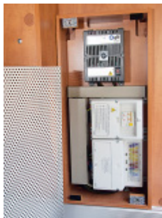
Ein Lochblech schützt die Elektrozentrale in der Heckgarage. Der Gasflaschenkasten sitzt angenehm tief und ist leicht zu bestücken.
