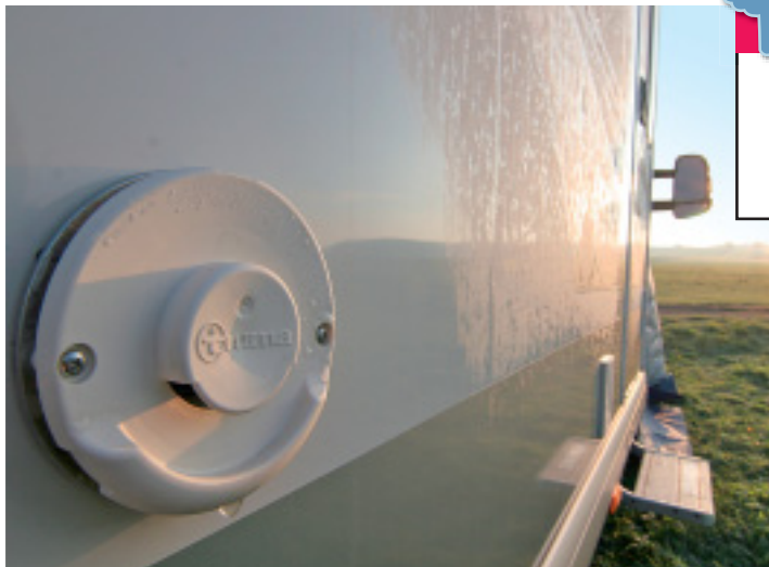
Heizung und Kühlschrank entlüften meist über die Fahrzeug-seite. Sitzt die Entlüftung des Kühlschranks auf dem Dach, sollte sie schneefrei gehalten werden.
