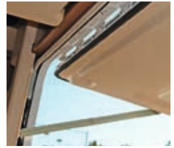
Zwei elektrisch angetriebene Spindeln mit automatischem Ausgleich bewegen die Klappe über zwei Streben.
