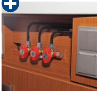
Die Gasabsperrhähne sind fest montiert und leicht zu erreichen.
