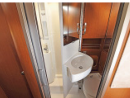
Die Rückwand des Badezimmers lässt sich samt Waschbecken nach vorn klappen. Sie schützt das Inventar vor Spritzern.
