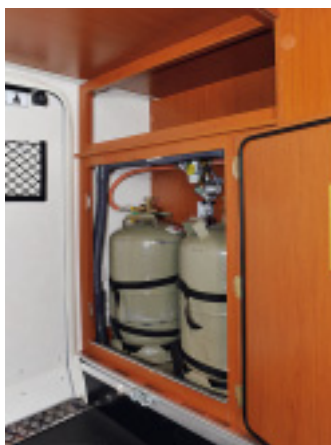
Die Gasflaschen stehen in einem separaten Fach in der Heckgarage.
