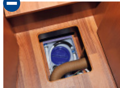
Hier besteht die Gefahr, den Warmluftschlauch zu beschädigen.
