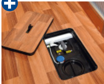
Das Ablassventil des Abwassertanks lässt sich vom Innenraum aus öffnen.
