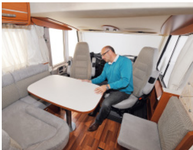
Der Tisch ruht auf einer stabilen Säule und kann in alle Richtungen verschoben werden. In der Mitte arretiert, lässt er sich sogar vom Klappsitz aus erreichen.
