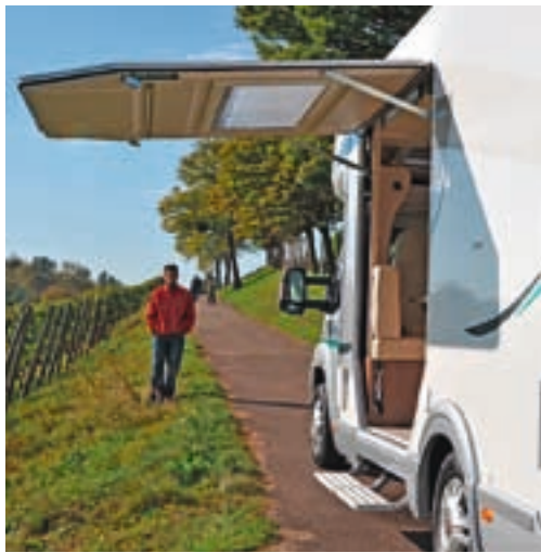
Oben: Die elektrisch angetriebene Klappe im Chausson ist die größte im Vergleich und dient geöffnet als Vordach.
