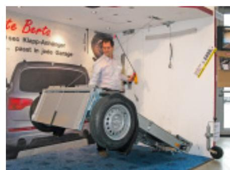
*Binnen Augenblicken lässt sich der Anhänger Tante Berta box zusammenklappen und an der Garagenwand deponieren. Hierbei leistet die mitgelieferte manuelle Seilwinde wertvolle Dienste.*
