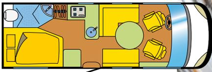
auch der Durchgang zwischen Küche und Kühlschrank beträgt gerade mal 50 Zentimeter. Klar, dass diese Bauart dem Stauvolumen der Küche zugute kommt, dem Raumgefühl ist es aber abträglich.
