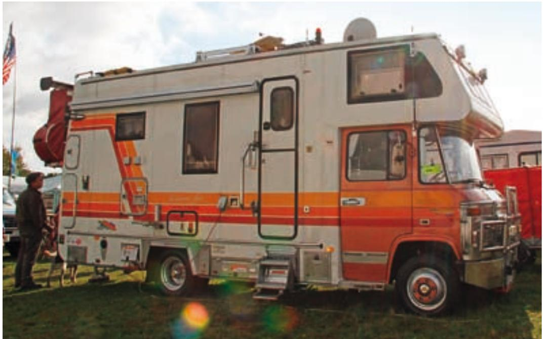
Für den Aufbau verwendete Havlik Sandwichpaneele, die man ansonsten beim Bau von Wohncontainern für Antarktis-Expeditionen einsetzt. „Mit acht Zentimeter Hartschaumisolierung, die Innenverkleidung besteht aus V2A und die Außenhaut aus verzinktem Blech.“
