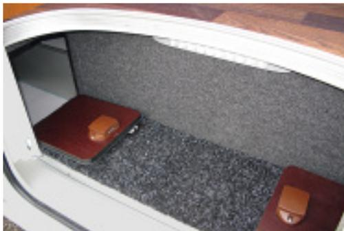
**Zwei mit Teppich verkleidete Kläppchen im Einstieg geben den Zugang zu je einem Staufach frei. Der hintere ist über eine Stauklappe auch von der Außenseite aus zugänglich.**
