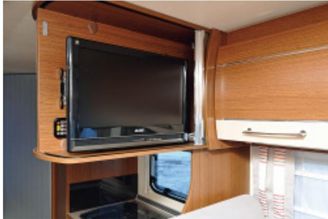
*Den Flachbildschirm montiert Bürstner zentral im Mobil. Er lässt sich an einer Schiene in die Mitte ziehen und umklappen – für TV-Genuss vom Heckbett aus.*
