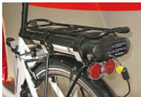
*Der neue Heckträger von Bürstner sitzt sehr tief und erleichtert damit das Beladen. Ein Elektroblock lädt den Fahrrad-Akku während der Fahrt.*
