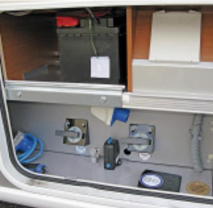
**Alles vereint: Stromanschluss, Batterie, Wasser-Einfüllstutzen, Ablaufventile.**
