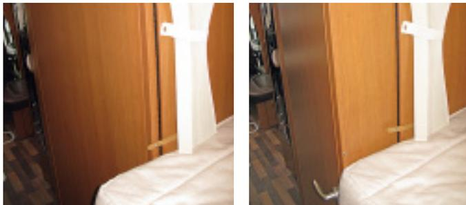
**Die hintere Wand der Nasszelle lässt sich samt der Raumbad-Tür um rund 15 Zentimeter ausziehen. So entsteht im Toilettenraum mehr Bewegungsfreiheit.**
