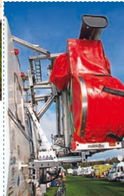
wie wir sie heute kennen noch nicht, Havliks Konstruktion ist genial und einfach. Eine alte Videokamera dient als Linse, ein Spiegel lässt sich so vor den Ausguck schwenken, dass Havlik über einen Monitor im 90-Grad-Winkel direkt hinter das
