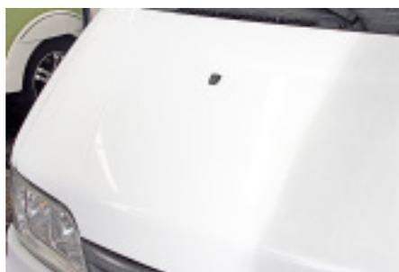
*Waschen allein reicht nicht (siehe links, rechte Hälfte der Haube). Auf verwitterten Lackoberflächen muss die Politur ran. Arbeitsaufwand für die Hälfte der Motorhaube – etwa fünf Minuten. Das Ergebnis überzeugt.*
