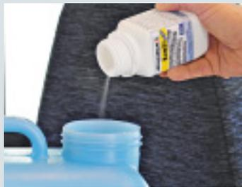
Diese Phase benötigt am meisten Zeit. Keim Ex löst Biofilme, eckige Beläge aus Mikroorganismen, Algen und Bakterien. Nachdem eine Lösung von 10 bis 20 Litern Wasser mit Keim Ex in den Tank gefüllt wurde, müssen alle Wasserhähne nacheinander kurz geöffnet werden, bis die Lösung ausströmt. Zu erkennen am perlenden Wasserstrahl. Jetzt heißt es acht Stunden warten, vorzugsweise über Nacht. Dann Wassertank entleeren und mit frischem Wasser nachspülen.
