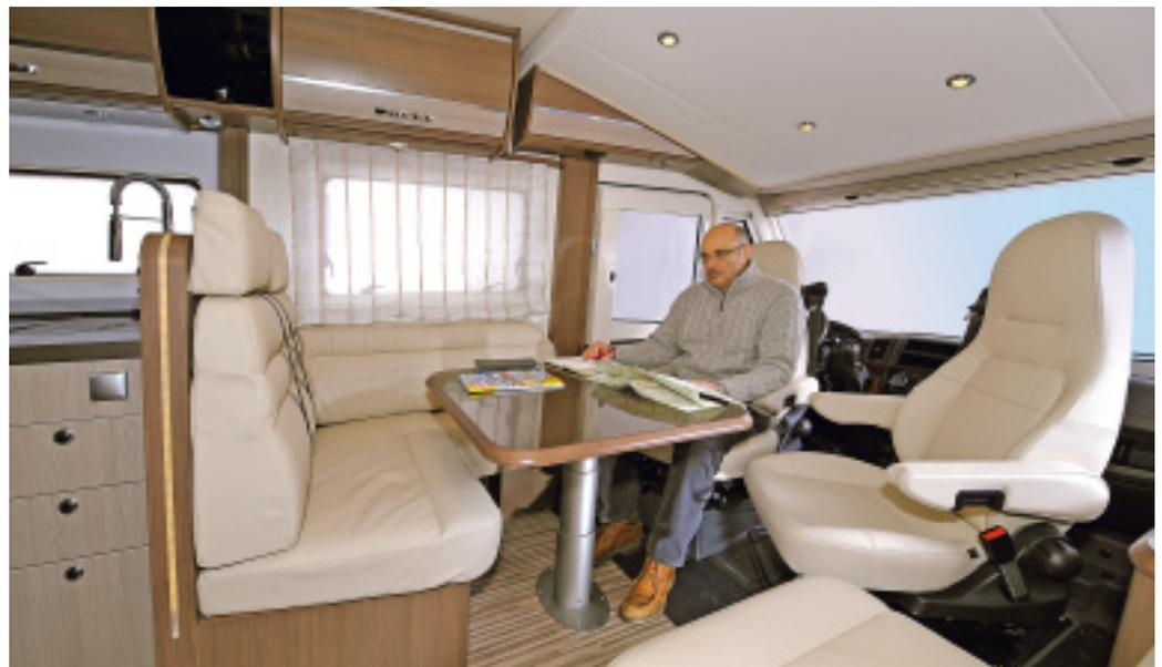
ins Fahrerhaus eben – ein Vorteil, den das Hochrahmenchassis ermöglicht. Auf einen Doppelboden verzichtet Adria.
