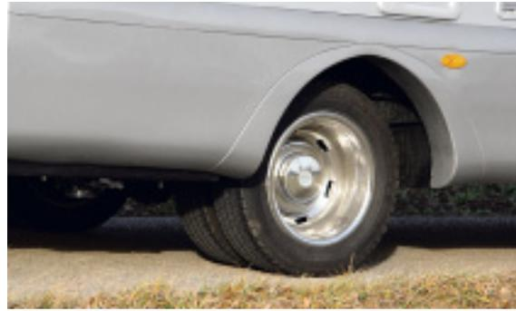
*Fescher Auftritt: Die Iveco-Hinterachse ist hinten doppelt bereift.*
