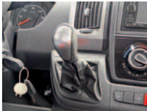
*Klassische Merkmale der Comfort-Matic: der Ölbehälter der Hydraulik und der Joystick im Armaturenbrett. Er ist anstelle des Schalthebels des Sechsganggetriebes montiert.*
