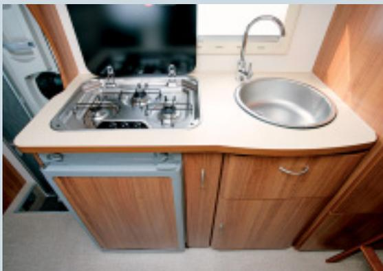
*Mitgedacht: Die Küchenarmatur ist mit weit nach oben geschwungenem Wasserhahn ausgestattet, im Doppelboden integriert Eura ein großes Schuhfach und der Ablasshahn für den Boiler wurde leicht bedienbar in der Heckgarage montiert.*
