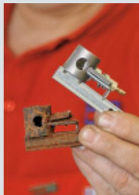
**Häufige Attacken mit dem Dampfstrahler oder Lagerung in einer feuchten Garage setzen auch dem Brenner zu. Hier eindrucksvoll im direkten Vergleich: Alt gegen Neu.**
