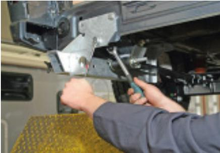
**Die Monteure verschrauben den fahrzeug-spezifischen Montagesatz für den Citroën am Rahmen.**
