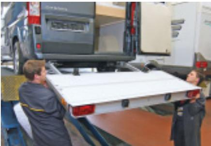
**Anschließend lässt sich der Träger problemlos in die Rohre schieben und mit den Rändelmuttern fixieren. Ebenso schnell gelingt die Demontage.**
