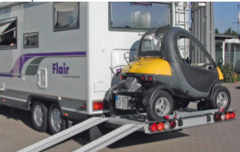
**Bis zu 250 Kilogramm stemmt die Heckplattform von Fiedler. Diese Last verlangt aber nach einer tragfähigen Hinterachse.**
