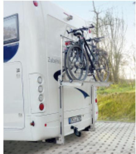
**Dank leistungsfähiger Gasdruckfedern gelingt selbst das Anheben zweier E-Bikes ohne hohen Kraftaufwand.**
