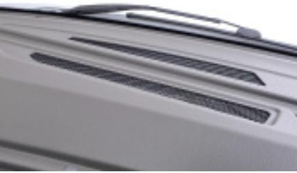
Die Konvektoren der Alde-Heizung sind im Armaturenbrett eingelassen.
