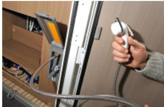
Von der Heckgarage aus ist die Druckpumpe der Wasserversorgung frei zugänglich, ebenso wie der Anschluss der Außendusche.
