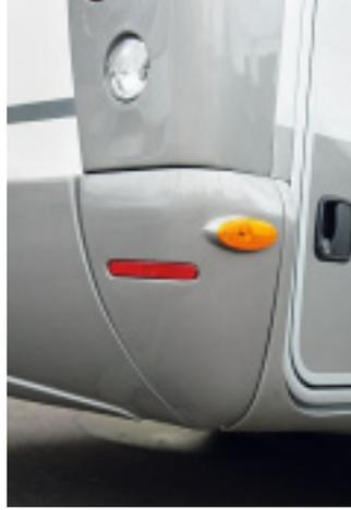
*Trotz Monocoques lässt sich der Stoßfänger nach Remplern wechseln.*
